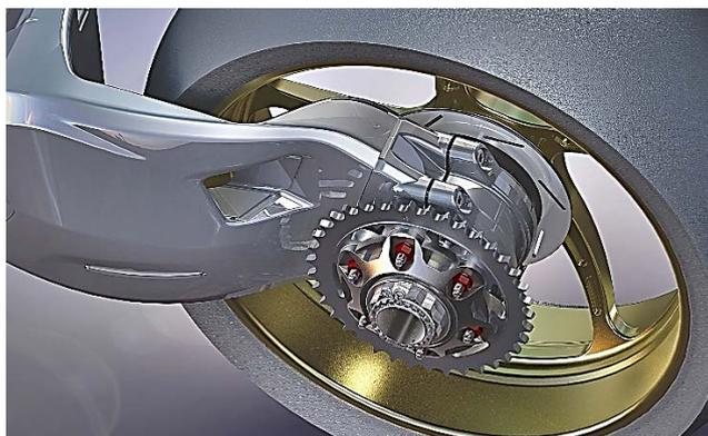
*Figura I.16. Basculante monobrazo con la corona de la cadena en la zona exterior.*
