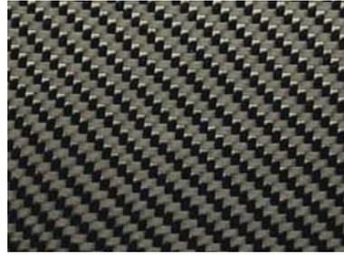
*Figura III.71. Malla de fibra de carbono, donde se pueden ver las hebras y el trenzado.*
