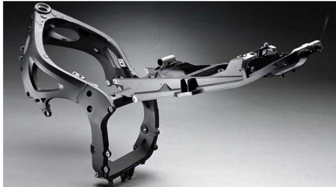
*Figura I.5. Chasis de doble viga de la Honda CBR.*
