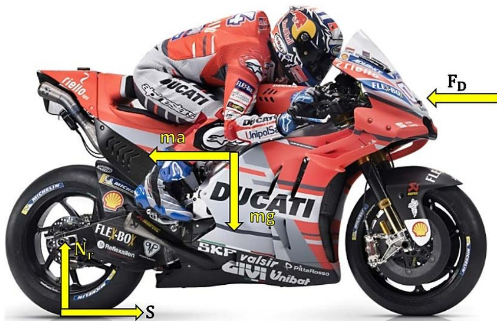
Figura III.67. Diagrama bidimensional, aceleración longitudinal.
