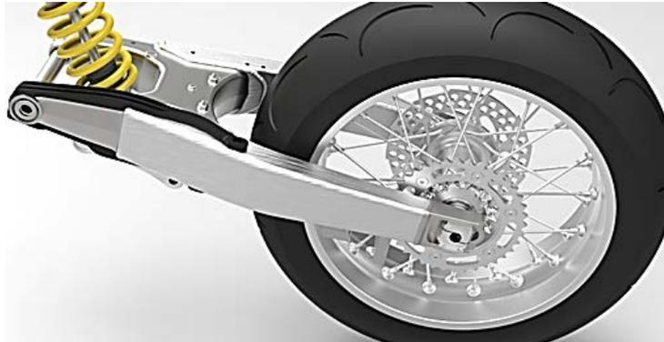
Figura I.17. Basculante de doble brazo con la corona de la cadena en el interior.
