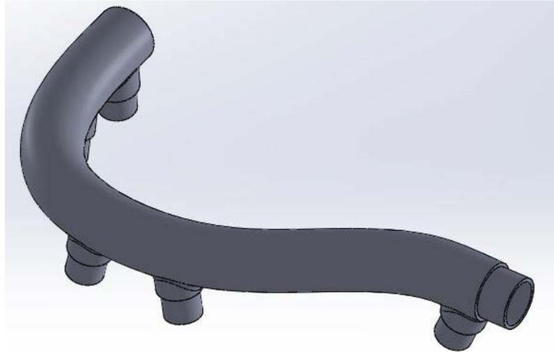
Figura III.13. Resultado final, tras incluir los amarres de los pilares, y el amarre de la rueda trasera.
