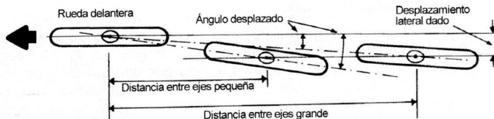
Figura III.49. Una distancia entre ejes grande mejora la estabilidad direccional.
