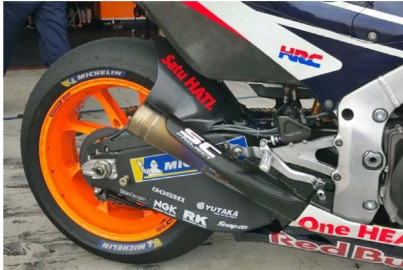
*Figura I.21. Basculante de fibra de carbono implementado por el equipo Honda en MotoGP*
