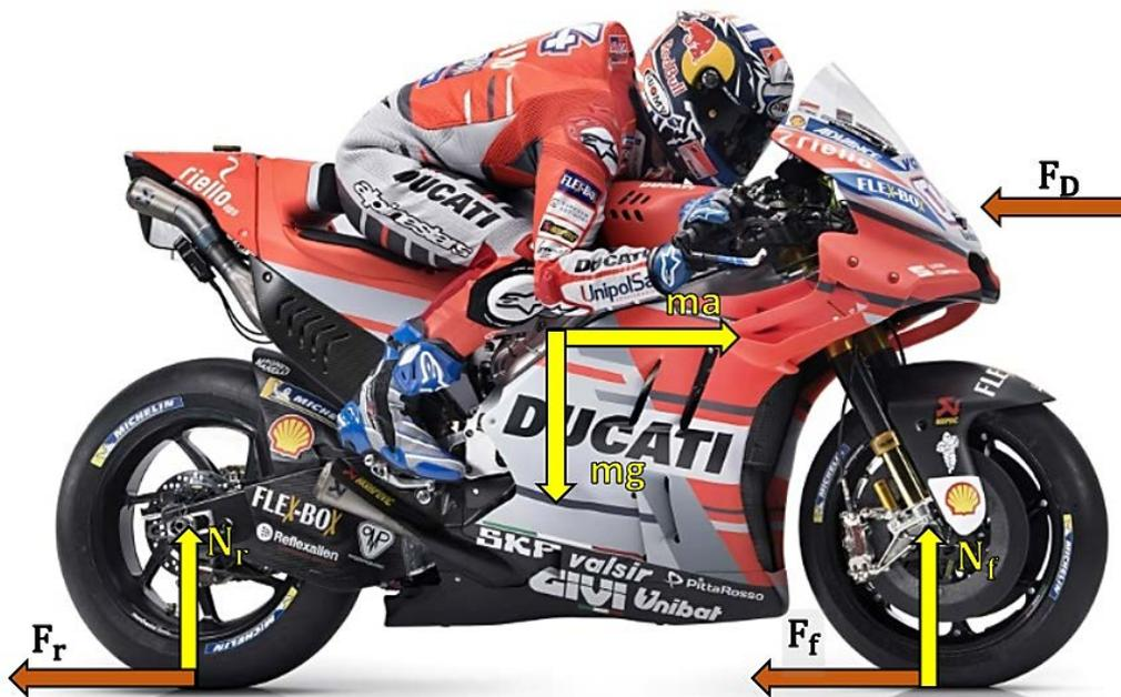
Figura III.68. Diagrama bidimensional, deceleración longitudinal.
