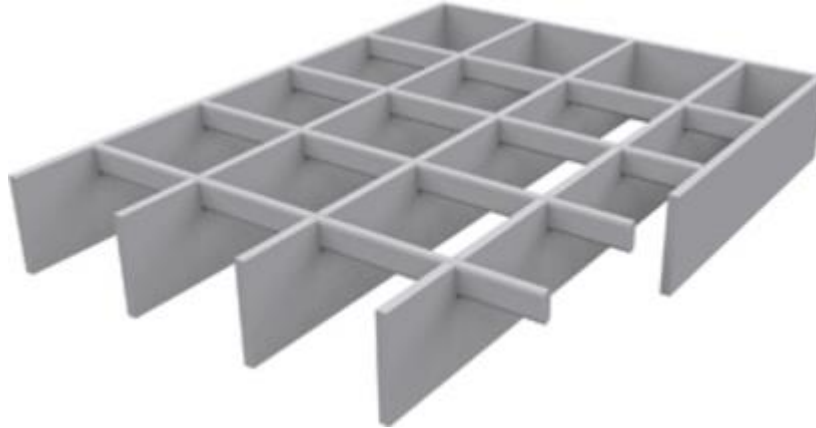
Ilustración 20 Vista 3D rejilla electrosoldada.
