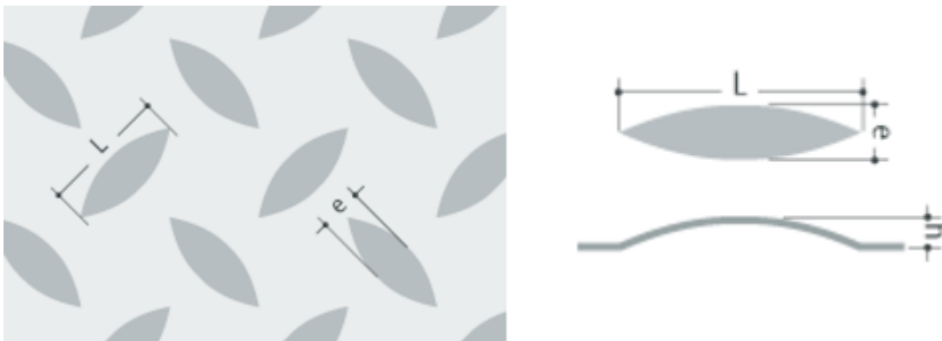
Ilustración 17 Patrón y dimensiones chapa lagrimada según DIN 59220:2000.
