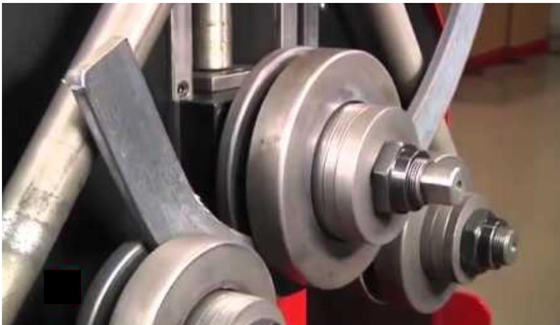
Ilustración 7 Curvadora de perfiles.
