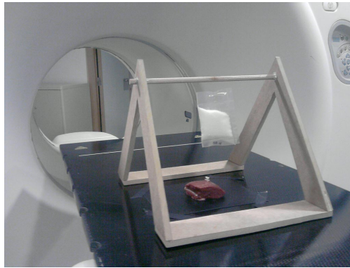
Figura 5.3: Dispositivo que deforma controladamente el hígado. En la foto se ejerce una presión de 20g sobre la superficie del órgano.
