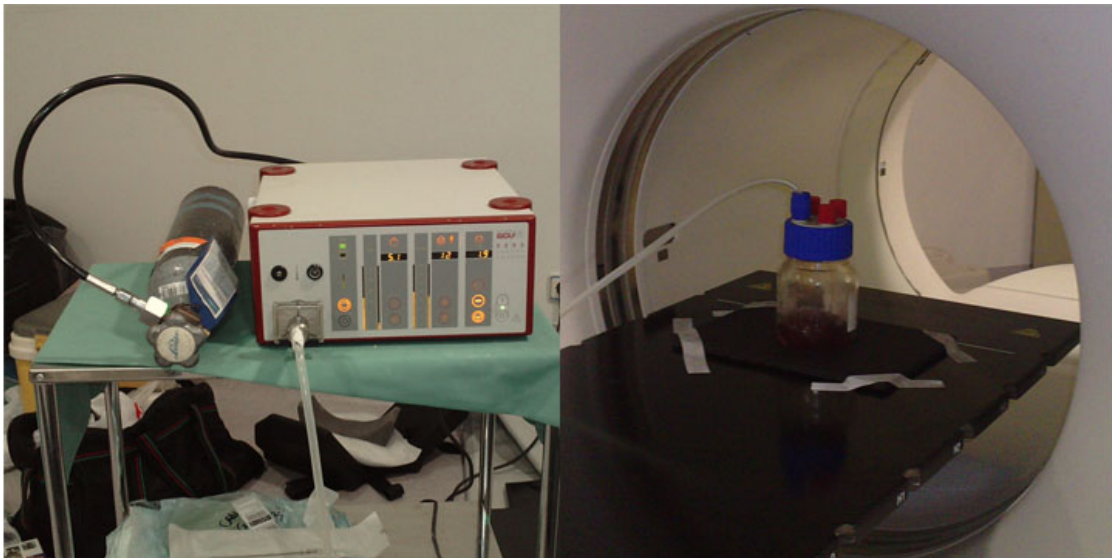
Figura 5.1: Experimento para la simulación de la técnica del pneumoperitoneo. A la izquierda, el dispositivo que insufla gas de forma controlada. A la derecha, el bote con la muestra de hígado de cordero dentro, el cual es escaneado en una TC y en el que se inyecta el gas.
