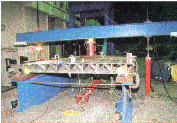
(a) Ensayo de un panel de tablero de puente
