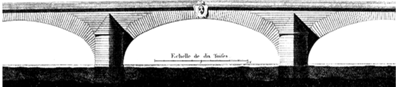
Coupe de la partie du Pont dont deux piles ont été déchargées .
