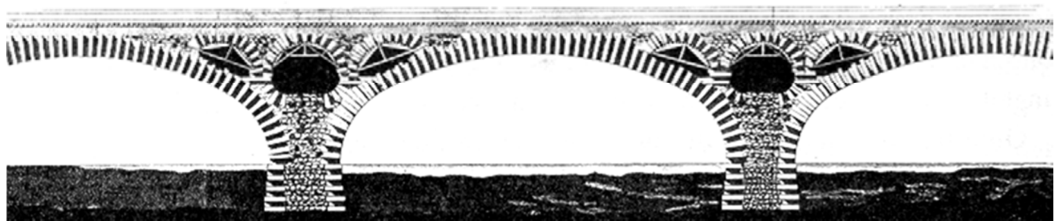
Coupe de la partie du Pont dont deux piles ont été déchargées .
