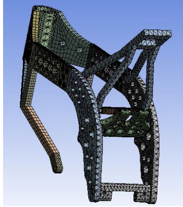
Figura 6-26. Mallado del caso aceleración máxima.
