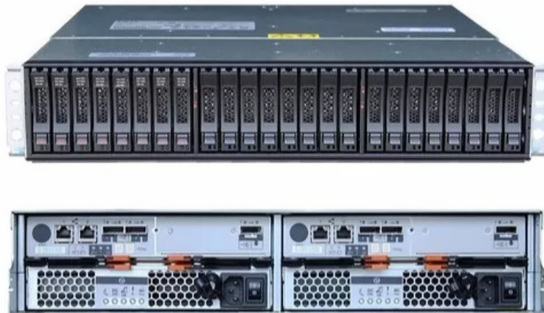
Ilustración 21 - Cabina IBM DS 3524
