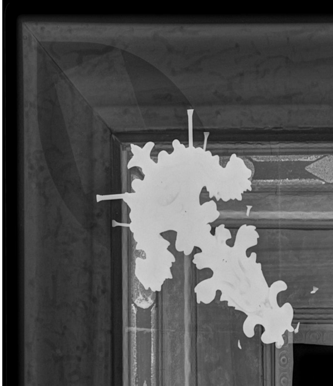
Imagen 92. Detalle del ensamblaje con llave o lambeta con fotografía de rayos X.
