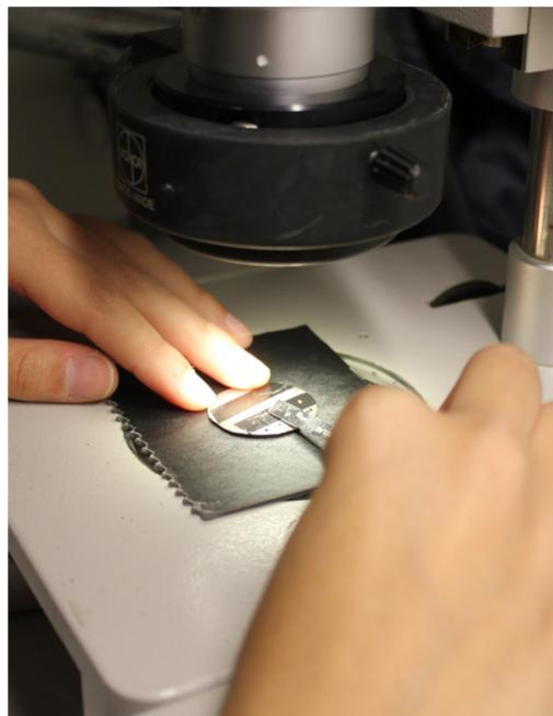
Imagen 62. Colocación de las muestras en la cinta de carbono con la ayuda del microscopio óptico.
