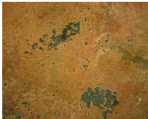
Imagen 96. Detalle de las costras de corrosión (Tenorita). Dino-Lite special lighting.
