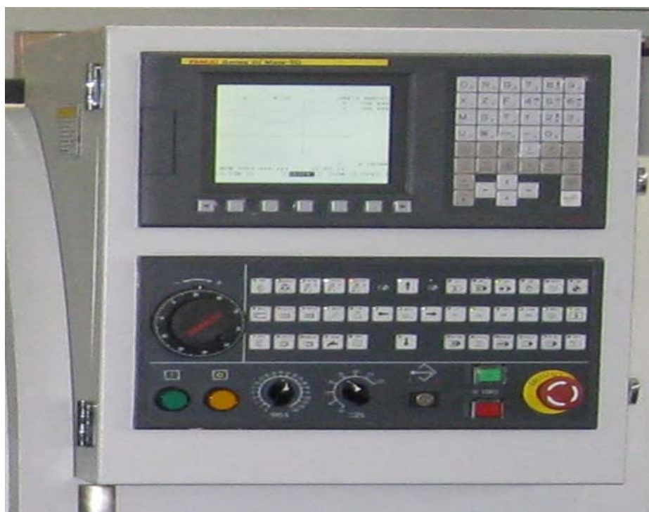
Figura 4: Detalle del panel del control numerico
