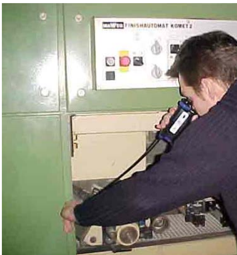
Figura 15: Inspección por medio del boroscopio
