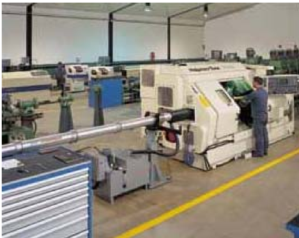
Figura 21: Torno con alimentador automatico, partiendo de barra.
