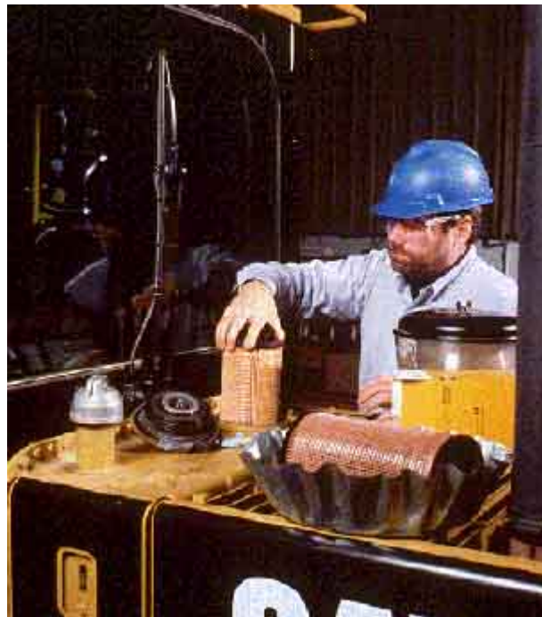
Figura 32: Limpieza manual de filtros
