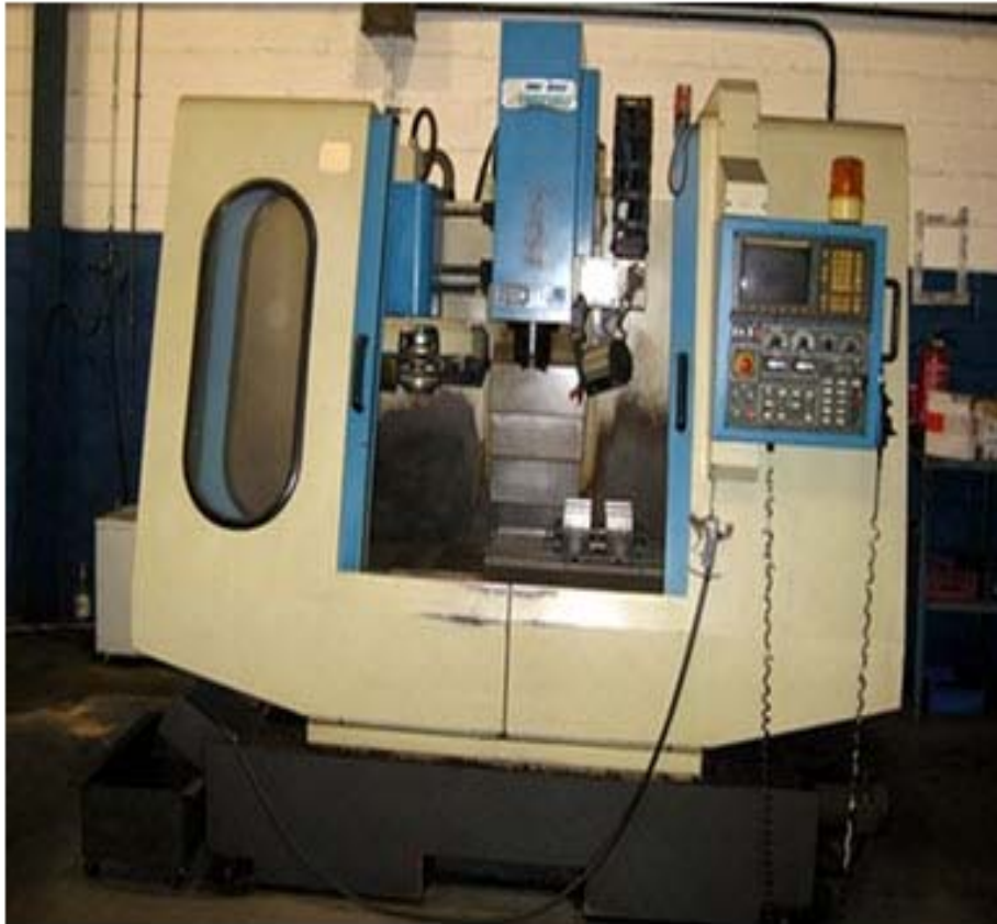
Figura 5: Detalle de un centro de mecanizado con control numerico, puede observarse que es una maquina para mecanizar pequeñas piezas.
