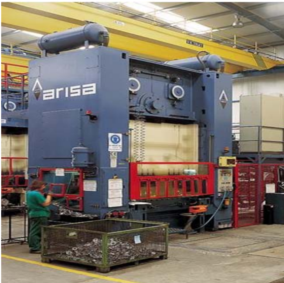
Figura 1: Prensa realizando labores de embutición
