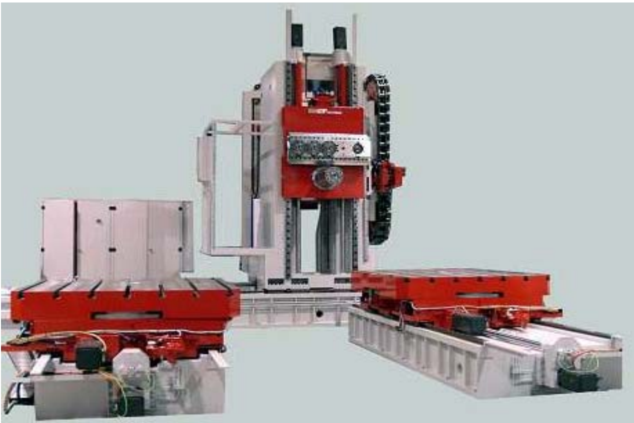
Figura 19: Centro de mecanizado con dos palets, externaliza los tiempos de amarre y desamarre de pieza
