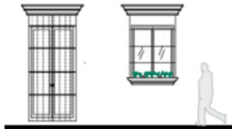
El hierro forjado protegía los ventanales y las puertas de madera de caoba. Fuente Propia.
