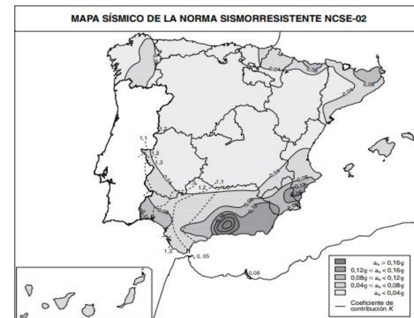
Figura 23. Mapa de peligrosidad sísmica. Fuente: Norma de Construcción Sismorresistente.
