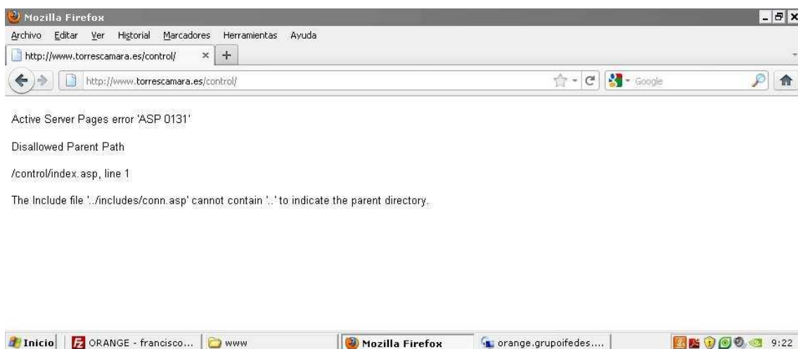
Imagen 9: Fallo provocado por la utilización de dos puntos (..) para referirse al directorio anterior sin habilitar la opción del IIS
