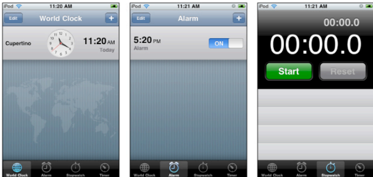
Ilustración 51 - Ejemplo de funcionamiento del UITabBarController
