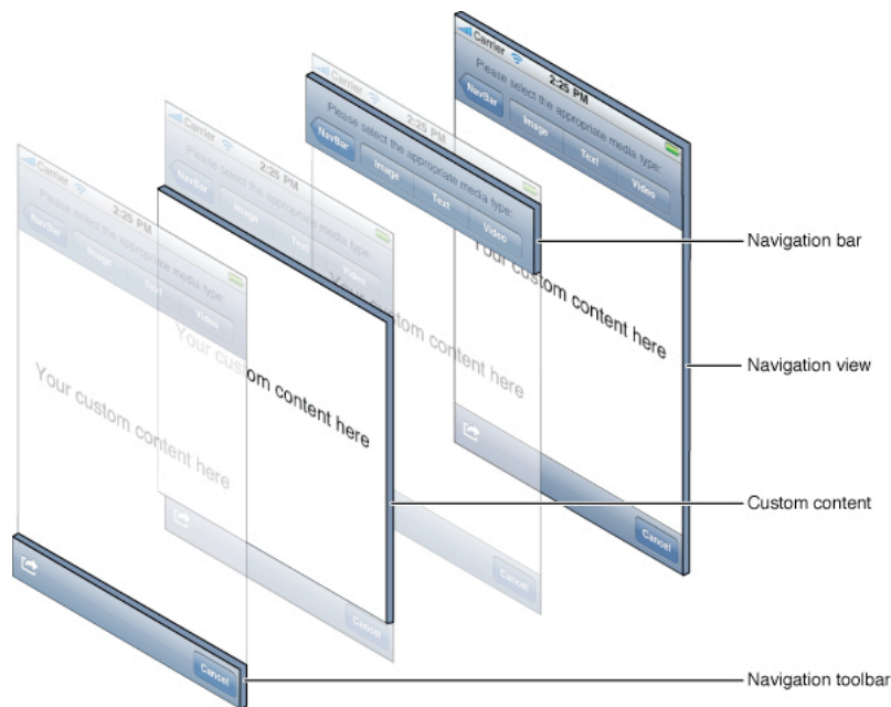
Ilustración 48 - Estructuración del UINavigationController
