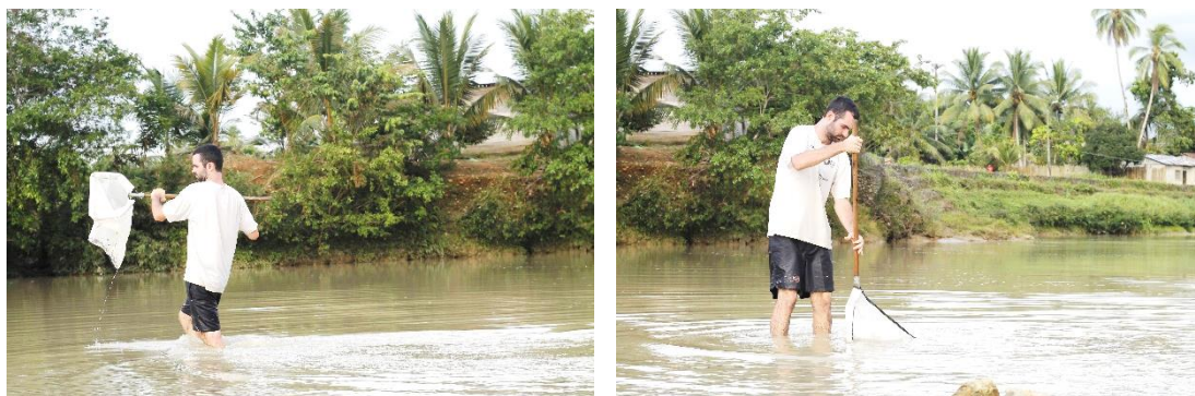
Figura 13. Utilización de la red de patada ( kick net ) para realizar el muestreo de macroinvertebrados bentónicos.
