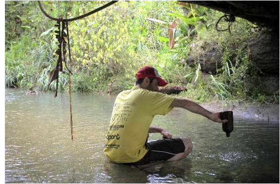
Figura 9. Toma de muestras de agua para realizar posteriormente las mediciones de turbidez y STD. De estas botellas se tomaron las alícuotas de donde se determinaron las concentraciones de metales.
