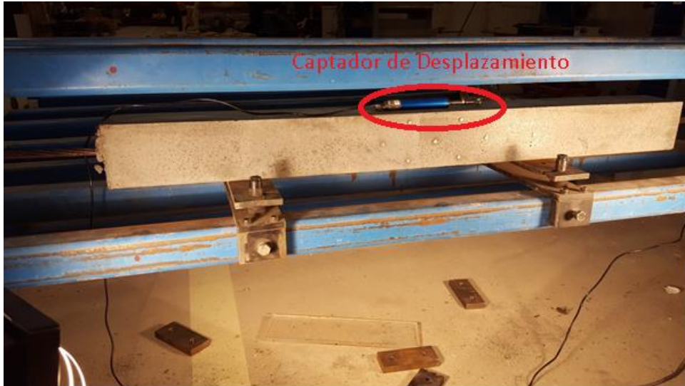
Fig 54.- Disposición del captador de desplazamiento para medición entre discos DEMEC. (Fuente Propia)
