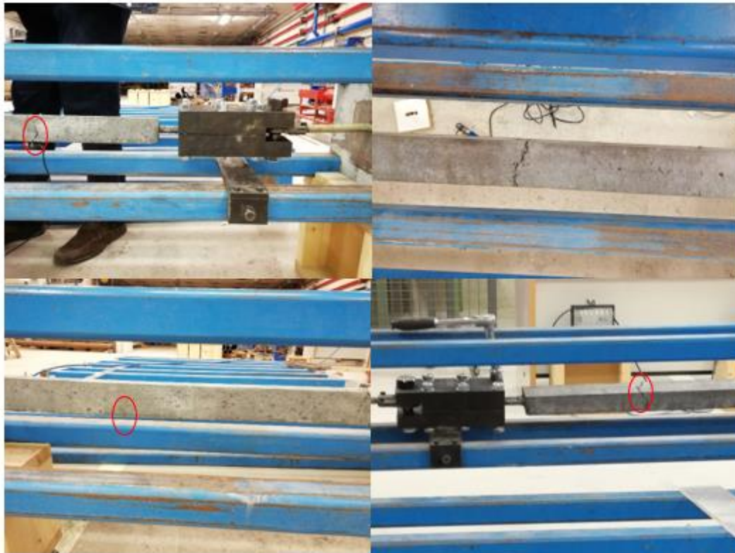
Fig 64.- Fisuras producidas en el tirante con las mordazas. (Fuente Propia)
