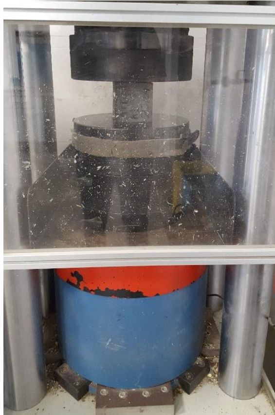
Fig 69.- Ensayo de Compresión de las probetas cubicas del Hormigón de muy Alto Rendimiento. (Fuente Propia)
