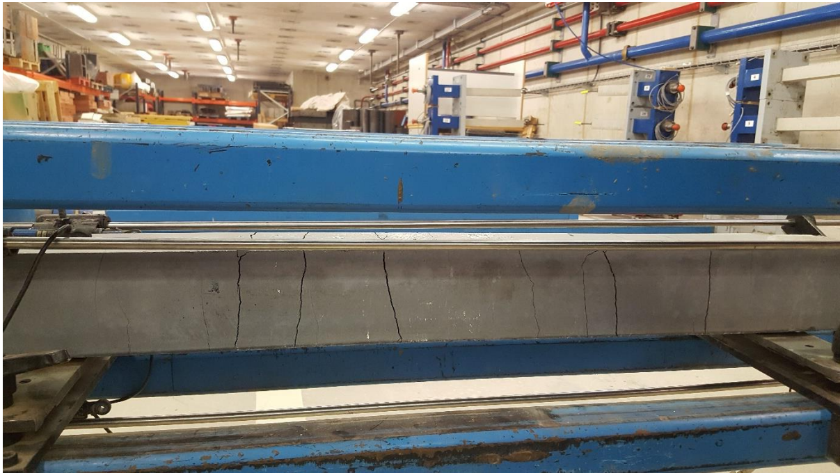
Fig 42.- Fisuras producidas en el primer ensayo realizado (Fuente propia)
