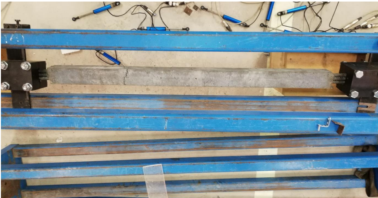
Fig 96.- Ensayo del tirante de Hormigón de muy Alto Rendimiento con 8 captadores de desplazamiento, 2 en cada cara y con las mordazas. (Fuente Propia)
