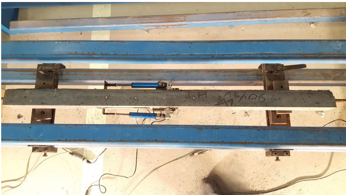
Fig 56.- Metodología de ensayo mediante 3 captadores y discos DEMEC. (Fuente Propia)
