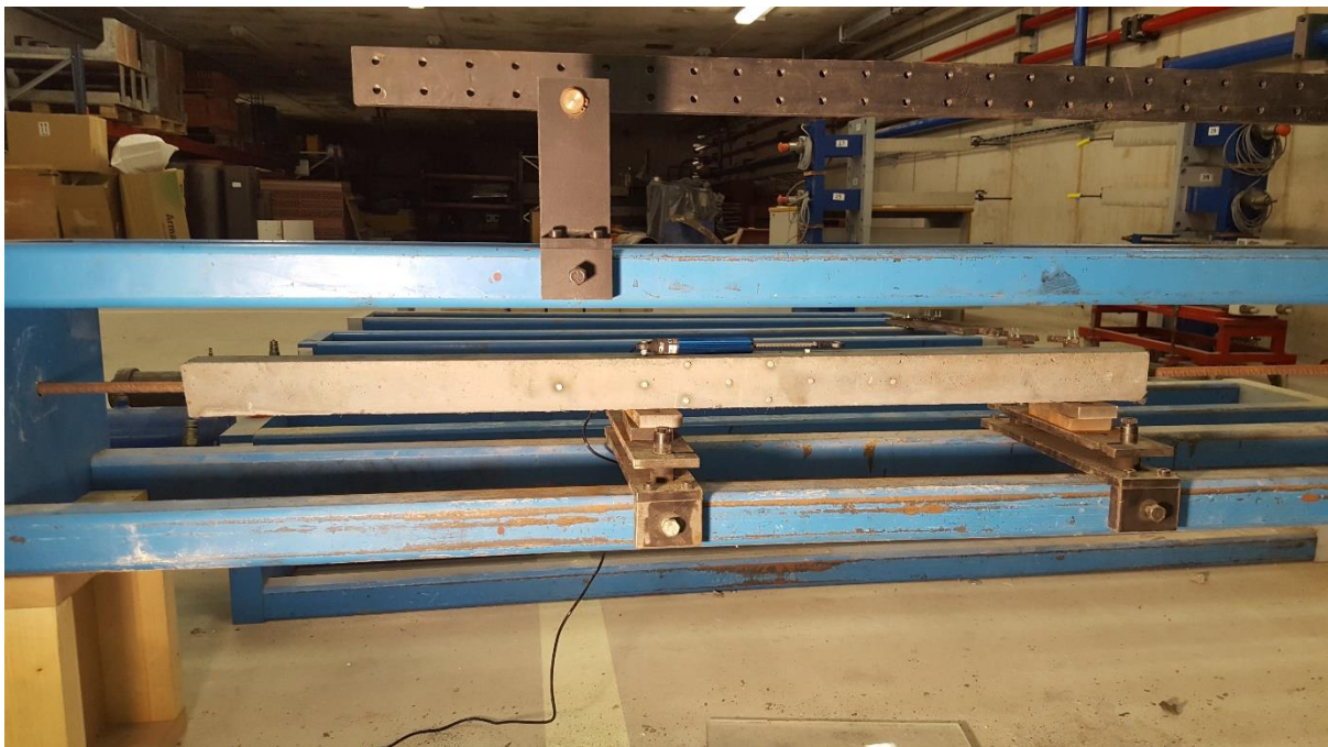
Fig 77.- Ensayo del tirante de Hormigón de muy Alto Rendimiento con discos Demec y con fotogrametría. (Fuente Propia)
