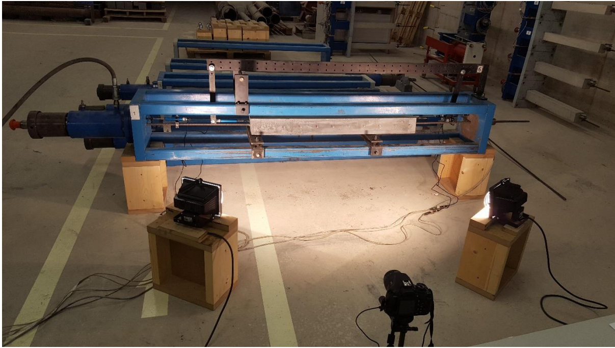
Fig 48.- Sistema de Medición mediante Captadores, discos “DEMEC” y Fotografías. (Fuente Propia)
