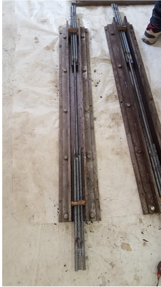
Fig 65.- Fabricación de los tirantes para la configuración de ensayo con las mordazas. (Fuente Propia)
