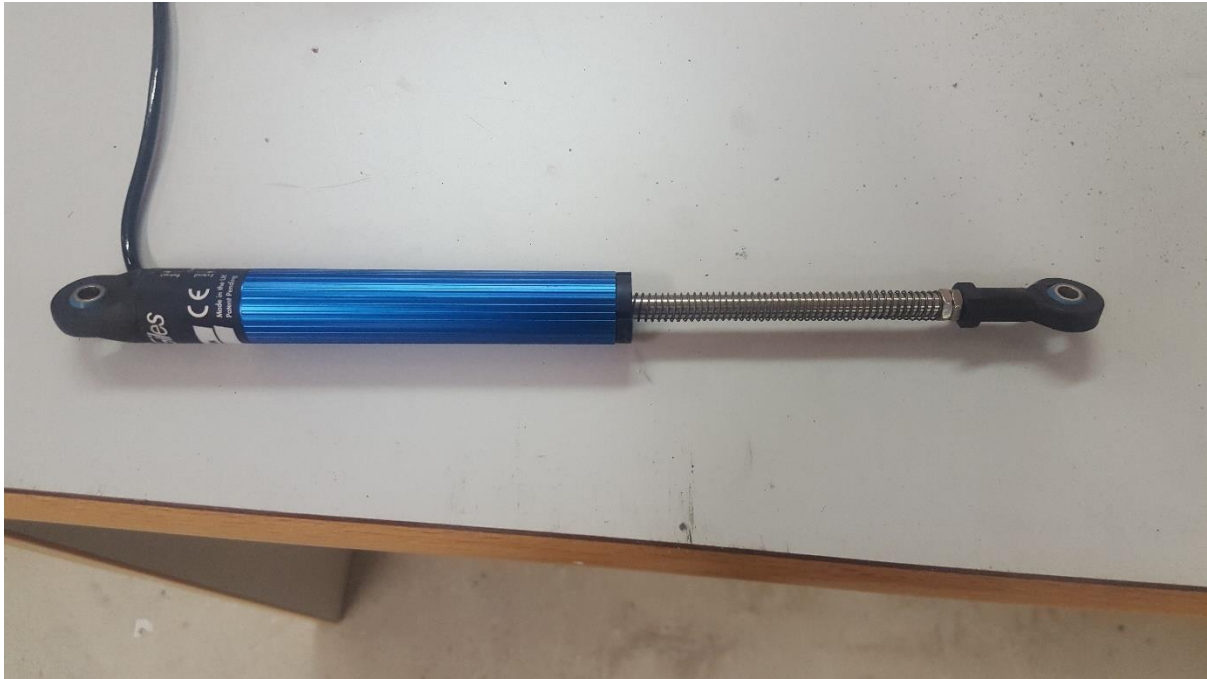
Fig. 35.- Transductor de Desplazamiento o LVDT
