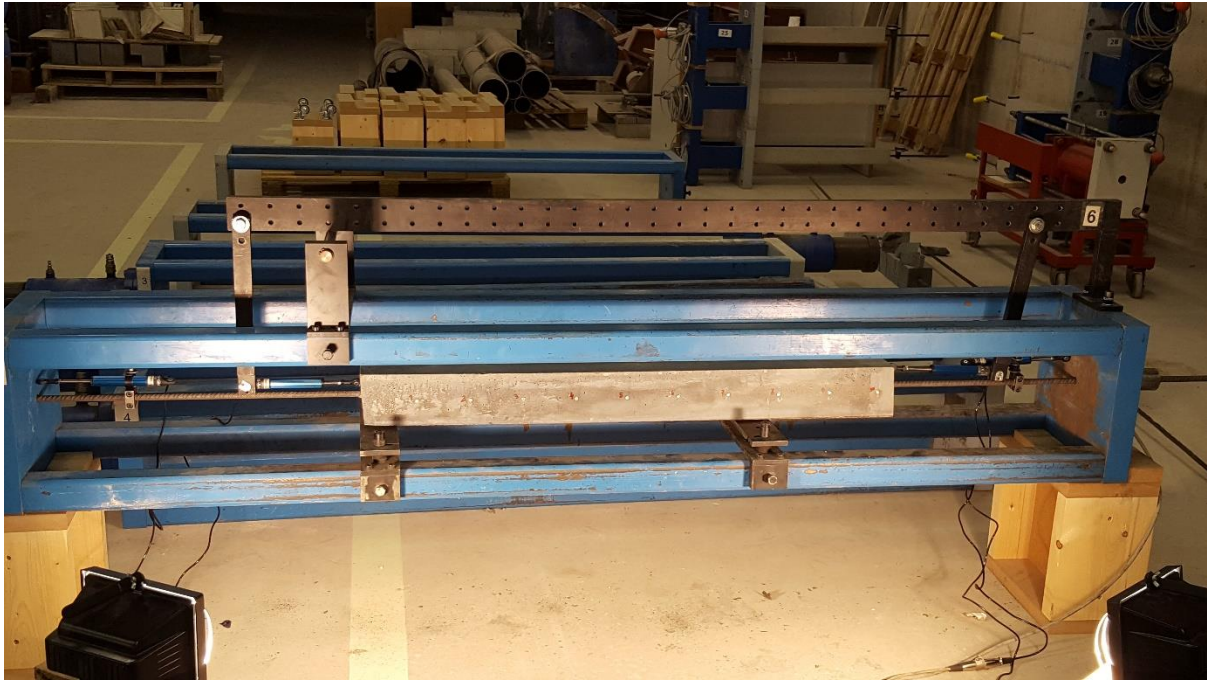
Fig 47.- Sistema de Medición mediante discos “DEMEC” (Fuente Propia)
