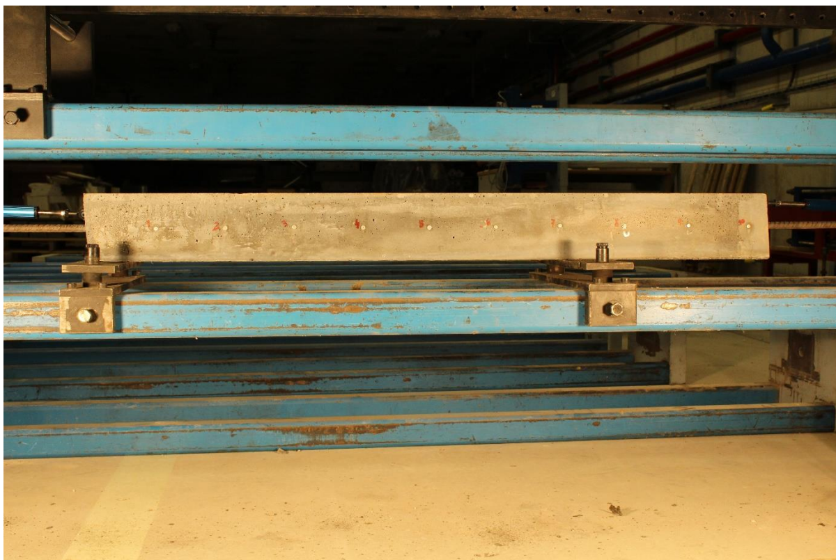
Fig 74.- Ensayo del tirante de Hormigón de muy Alto Rendimiento con discos Demec. (Fuente Propia)
