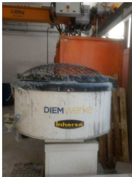
Fig 67.- Mezcladora Utilizada para la fabricación del Hormigón de muy Alto Rendimiento (Fuente Propia)
