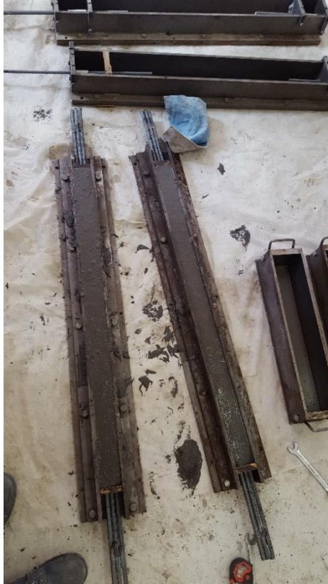
Fig 68.- Probetas de los tirantes después de hormigonado. (Fuente Propia)
