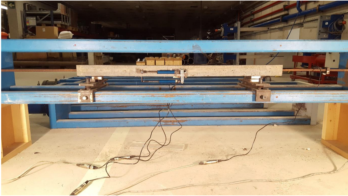
Fig 55.- Metodología de ensayo mediante 3 captadores y discos Demec (Fuente Propia)
