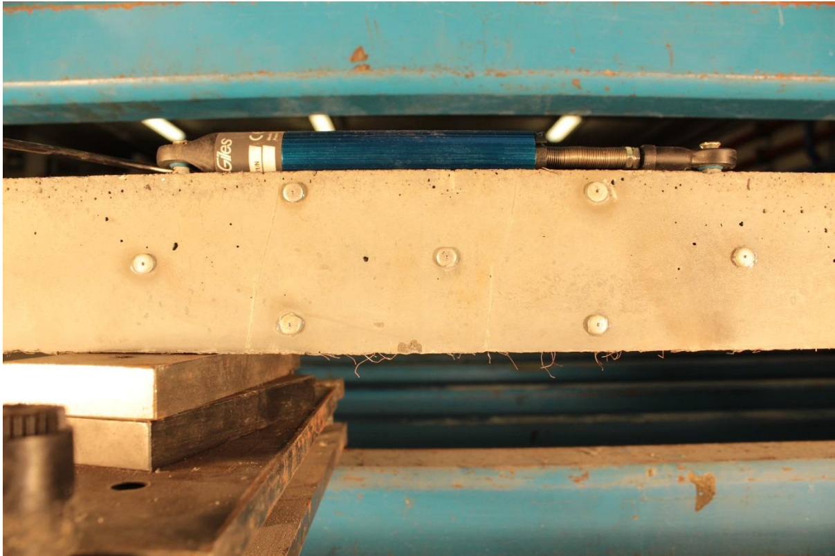
Fig 81.- Ensayo del tirante de Hormigón de muy Alto Rendimiento con discos Demec y captador de desplazamiento (Fuente Propia)
