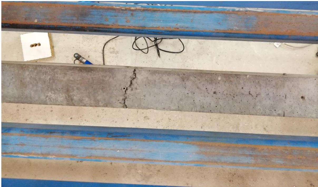
Fig 99.- Fisuras producidas en el ensayo mediante la configuración de las mordazas. (Fuente Propia)
