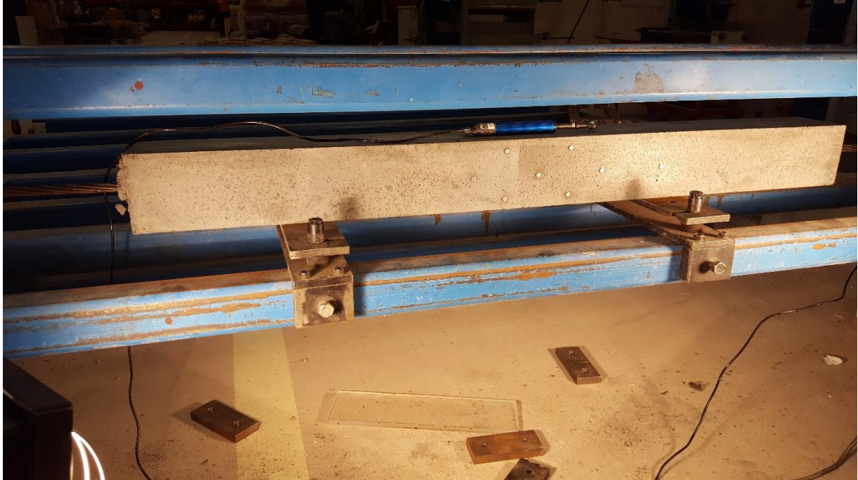
Fig 88.- Ensayo del tirante de Hormigón de muy Alto Rendimiento con cable de pretensado con discos Demec y captador de desplazamiento. (Fuente Propia)
