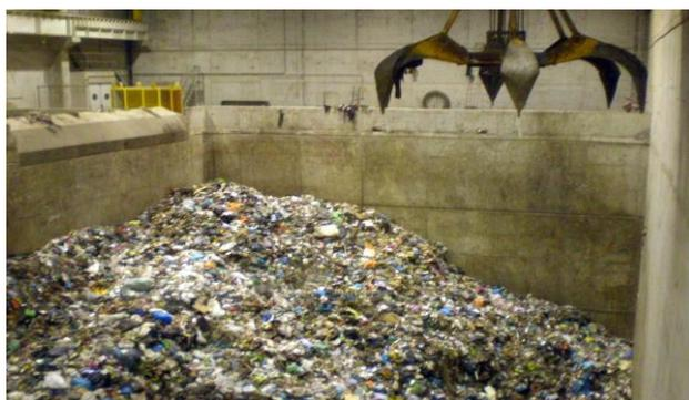
Figura 58. Pulpo hidráulico en foso de descarga. Fuente: ghcranes.com
