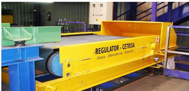
Figura 28. Separador por corrientes de Foucault seleccionado. Fuente: regulator-cetrisa.com
