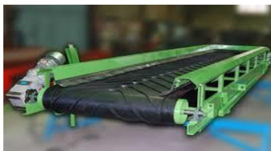
Figura 60. Cinta transportadora. Fuente: mtc-arm.com
