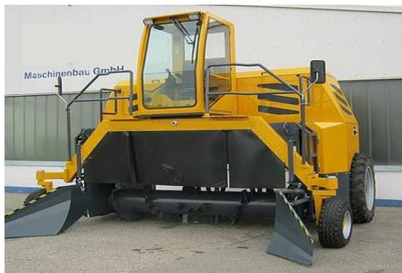
*Figura 49. Máquina volteadora seleccionada. Fuente: ritornamedioambiente.com*
