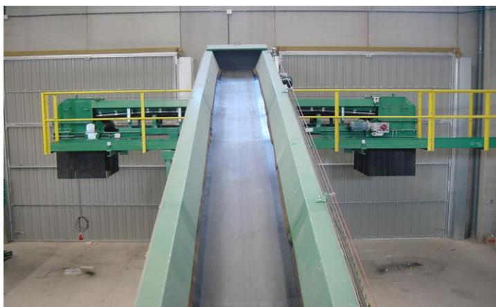
Fig 20. Cinta transportadora de alimentación al pretratamiento. Fuente: [bandastransportadoras.info](http://bandastransportadoras.info)
