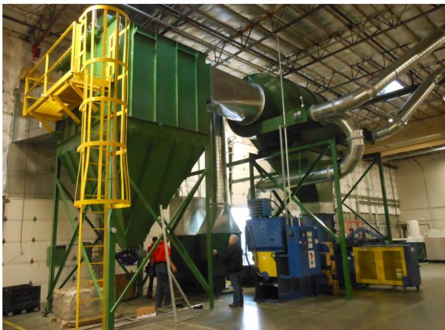
Figura 25. Separador aerodinámico seleccionado. Fuente: goettsch.com
