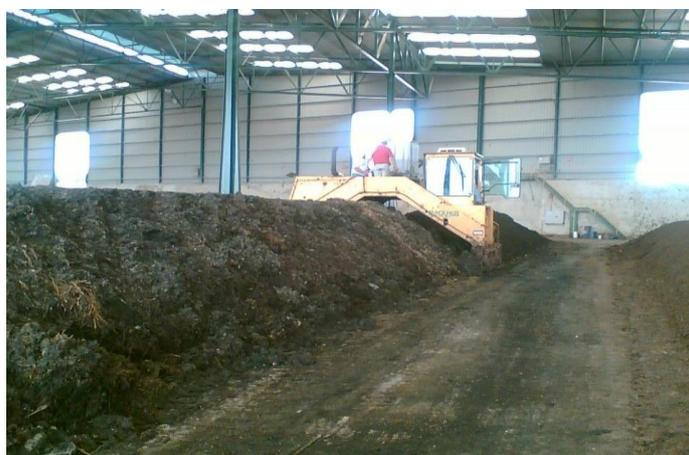
Figura 68. Compostaje en pilas volteadas. Fuente: maestrocompostador.es
