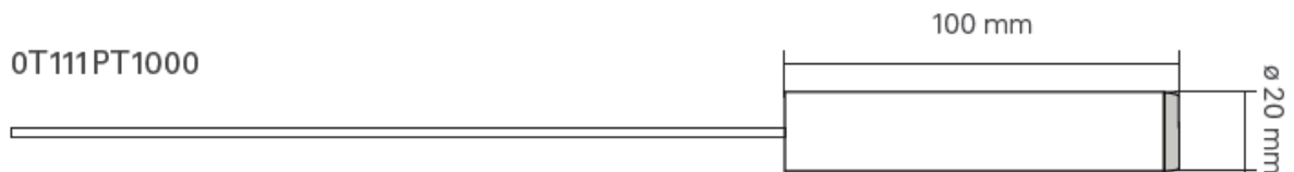
Figura 34: Esquema acotado sensor de temperatura OT111PT1000. Fuente: catálogo SISGEO.
