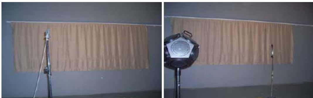
Figura I.4.3. Imágenes de la cámara reverberante durante el proceso de medida de unas cortinas textiles. Características de la cámara reverberante: Volumen de 238 m 3 , superficie total de 236 m 2 . Condiciones de medida: Señal tipo Ruido Rosa, tipo de análisis con bandas de un tercio de octava y de octava, temperatura entre los 21-23 °C, humedad relativa aproximadamente del 40% HR. Imagen tomada de proyectos de investigación realizados en AITEX.
