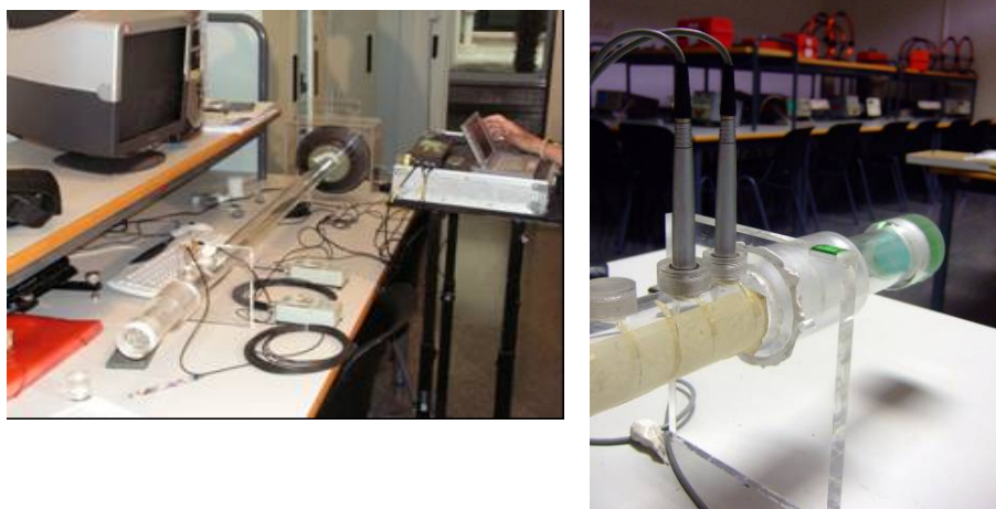
Figura III.3.7. Izda. Montaje medida coeficiente de absorción e impedancia en Tubo de Kundt. Decha. Detalle del montaje con la probeta colocada al final del tubo.
