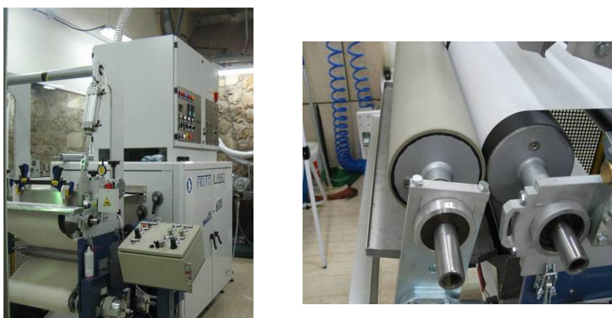
Figura III.2.3. Izda. Equipo Roto Labo para el procesado a la continua de acabados textiles. Decha. Detalle del módulo del foulard con el paso del tejido durante el escurrido.
