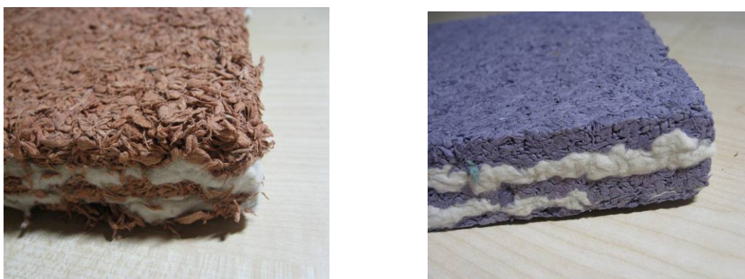
Figura I.4.7: Fotografías de paneles aislantes acústicos obtenidos a partir de residuos textiles mediante la compactación con prensa y molde a diferentes presiones y tiempos. Imagen tomada de proyectos de investigación realizados en AITEX.
