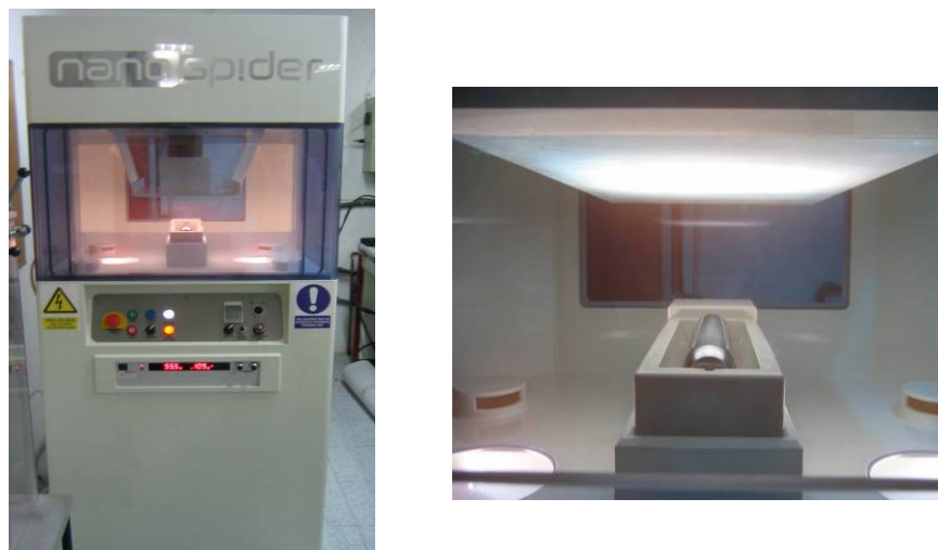
Figura III.2.4. Izda. Fotografía del equipo NS-Lab de AITEX. Decha. Fotografía de detalle de la cámara de reacción y formación de nanofibras.
