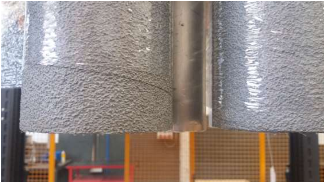
Ilustración 4: Ambos rodillos con un pre-estiro de 260%
