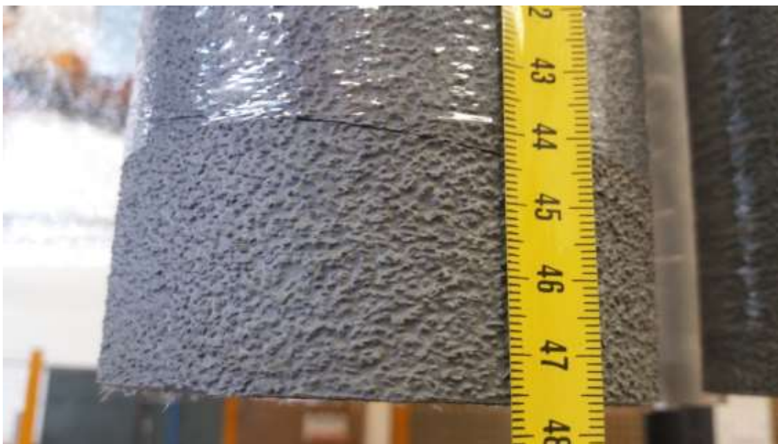
Ilustración 5: Segundo rodillo con un pre-estirado de 260%.
