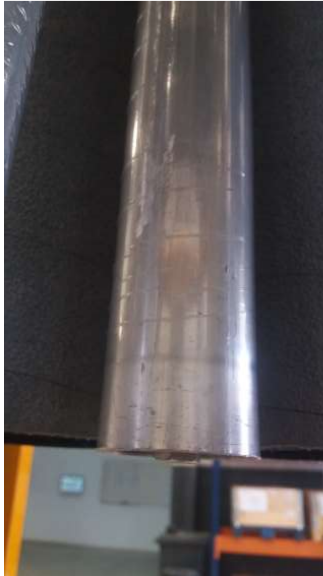
Ilustración 7: Estrías producidas en el rodillo loco intermedio entre los dos rodillos de tracción.
