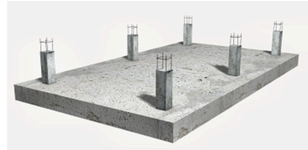
Imagen 7. Losa de Hormigón.
