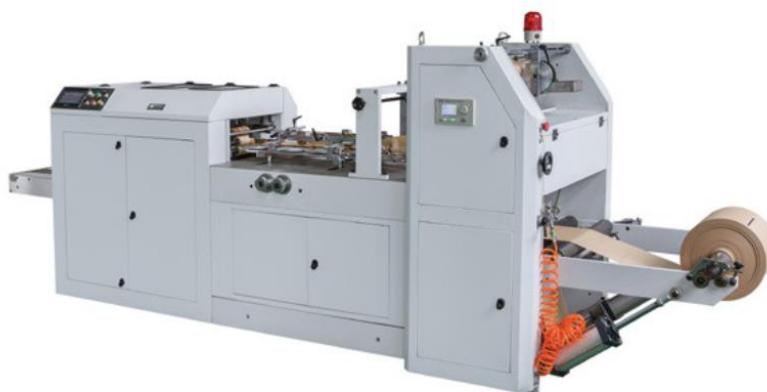
Ilustración 31. Máquina de fabricación de bolsa alimenticia de papel Kraft
