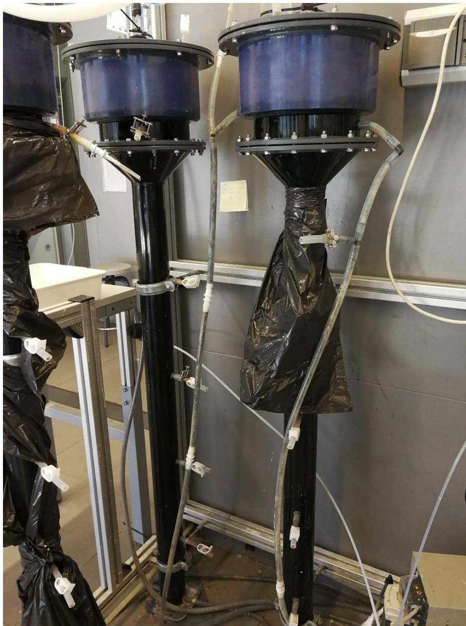
Ilustración 5 Montaje experimental a escala de laboratorio del reactor RAFA y RALF
