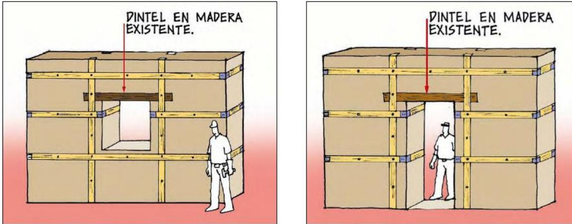
Figura 127 Disposición de fuerza con relación a los dinteles. FUENTE: (Asociación Colombiana de Ingeniería Sísmica, 2004).
