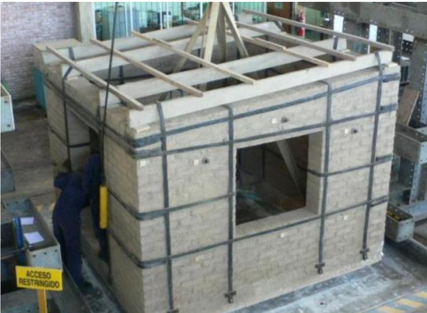
Figura 21 Sistema de reforzamiento estructural con tiras de llantas de carro recicladas. FUENTE: (Charleson, 2011).
