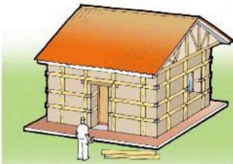
Figura 117 Sistema de refuerzo estructural con madera de confinamiento. FUENTE: (Asociación Colombiana de Ingeniería Sísmica, 2004).
