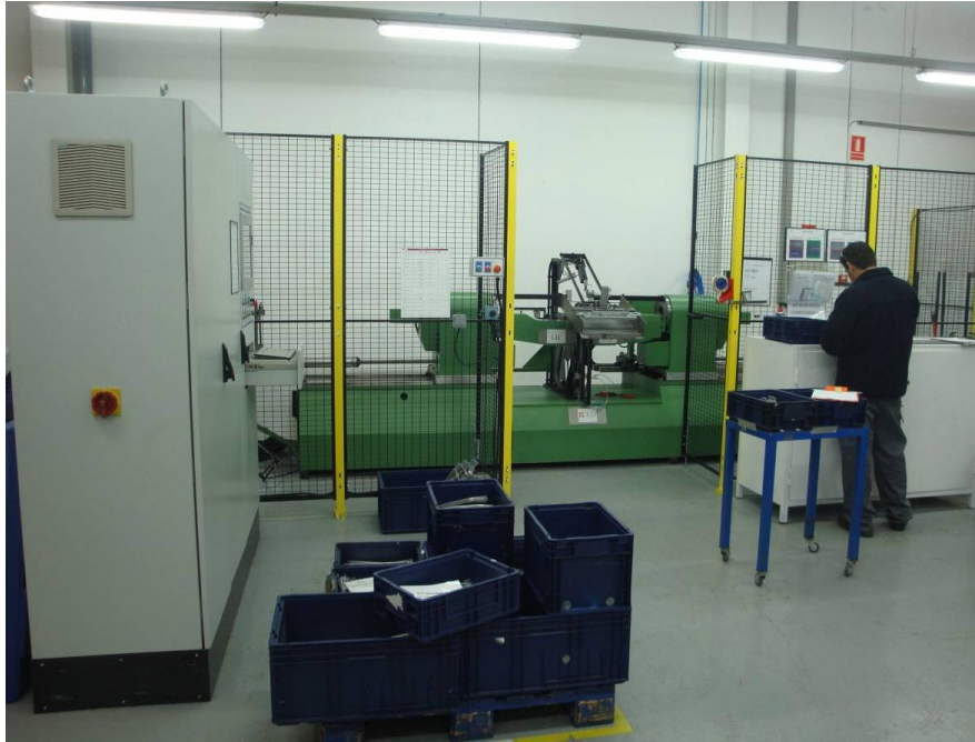
Máquina Dobladora tridimensional de varillas
