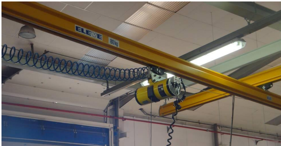
Polipasto para izado de parabrisas
