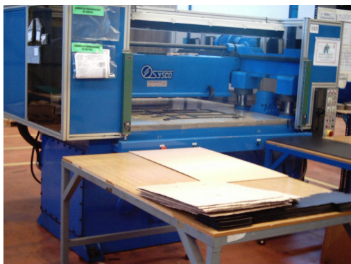
Prensa hidráulica para fabricación de espumas troqueladas.
