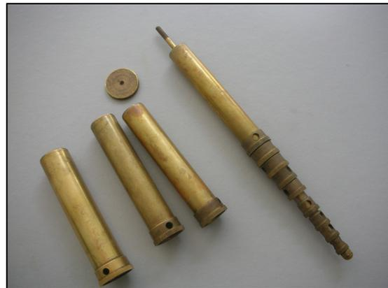
Figura 2. Sacabocados para realizar los discos de las hojas.
