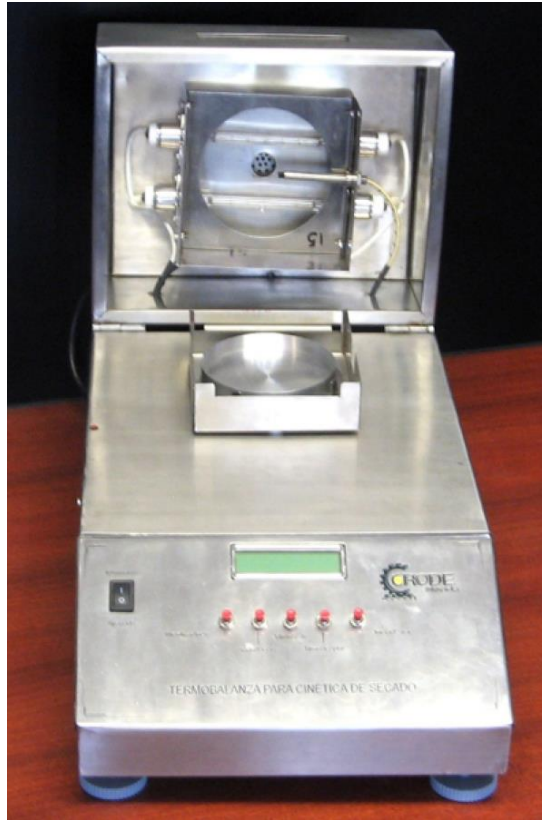
Ilustración 22: termobalanza. Propiedad de Smurfit Kappa.
