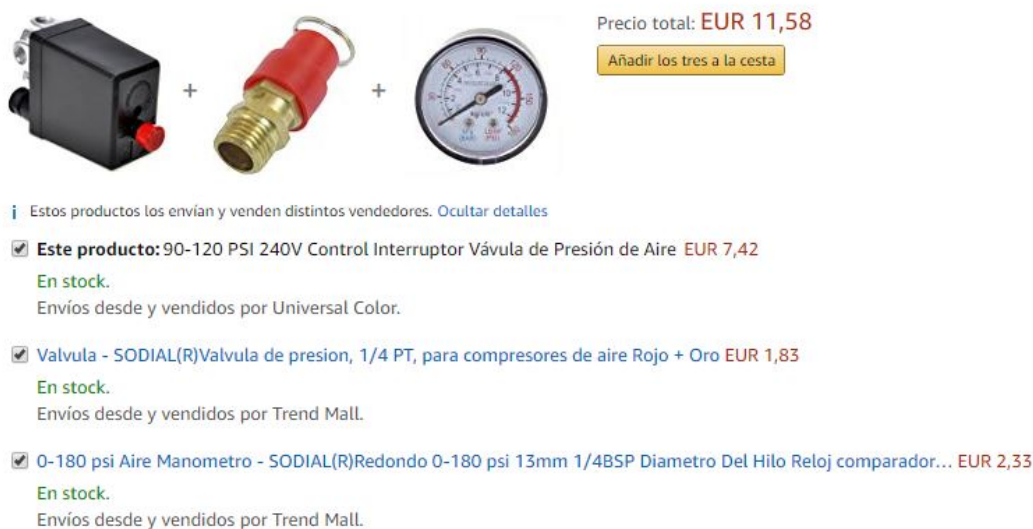
Fig.:43. Conjunto presostato, manómetro y válvula de seguridad
