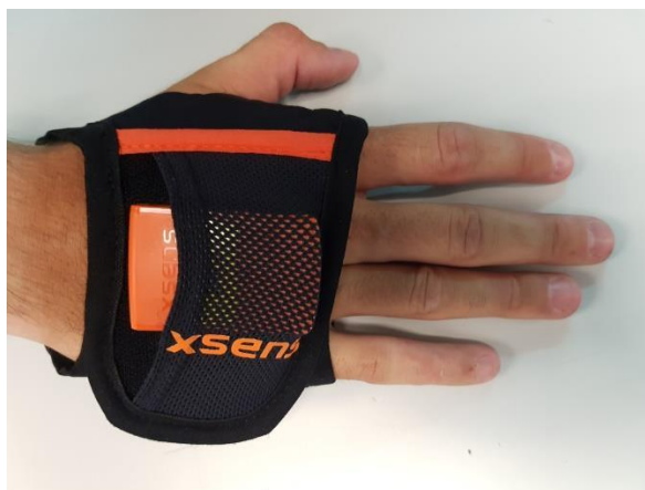
Figura 14. Sensor colocado en la mano derecha de un conductor.
