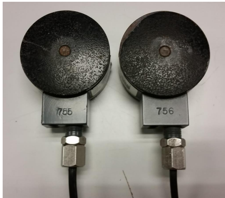
Figura 5. Células de carga. Izquierda: freno. Derecha: acelerador.
