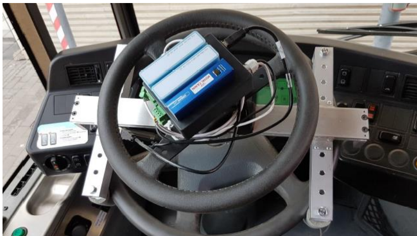
Figura 3. Instalación del medidor de par con el adaptador del volante [6].
