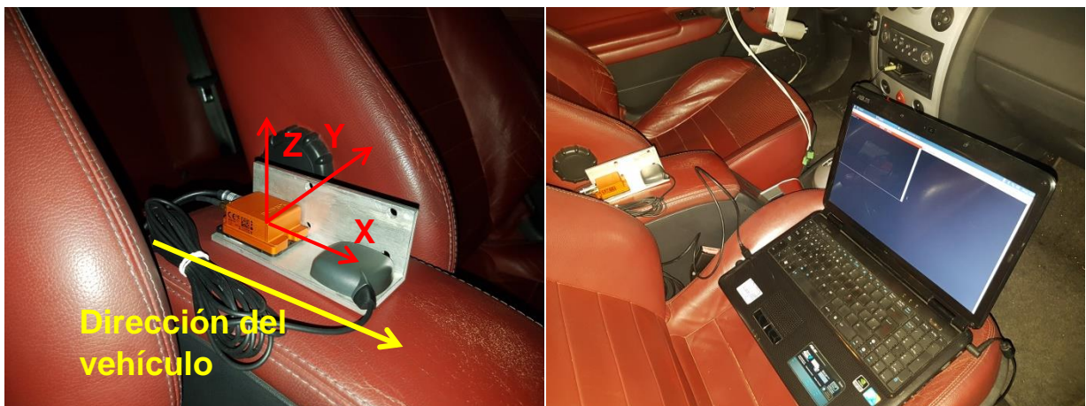
Figura 13. Montaje de la IMU junto con el ordenador.
