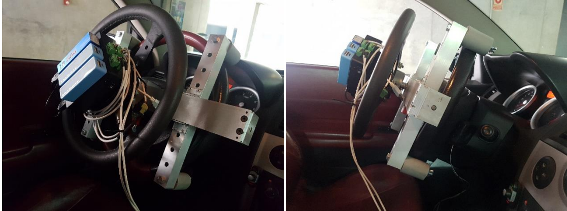
Figura 11. Medidor de par montado en volante
