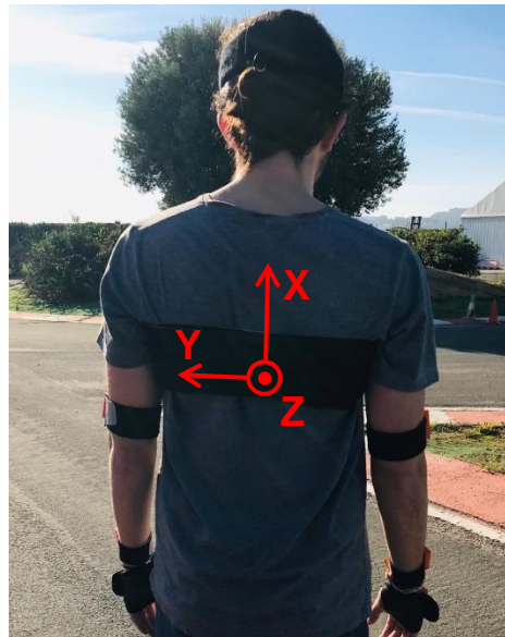
Figura 35. Sistema de coordenadas del sensor rastreador de movimiento humano situado en la espalda.
