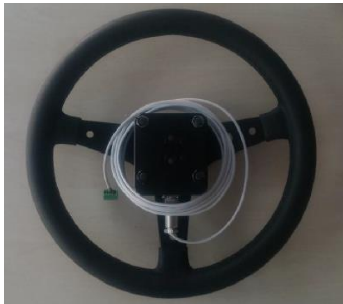
Figura 1. Sensor de par montado en un volante, vista en planta [6].
