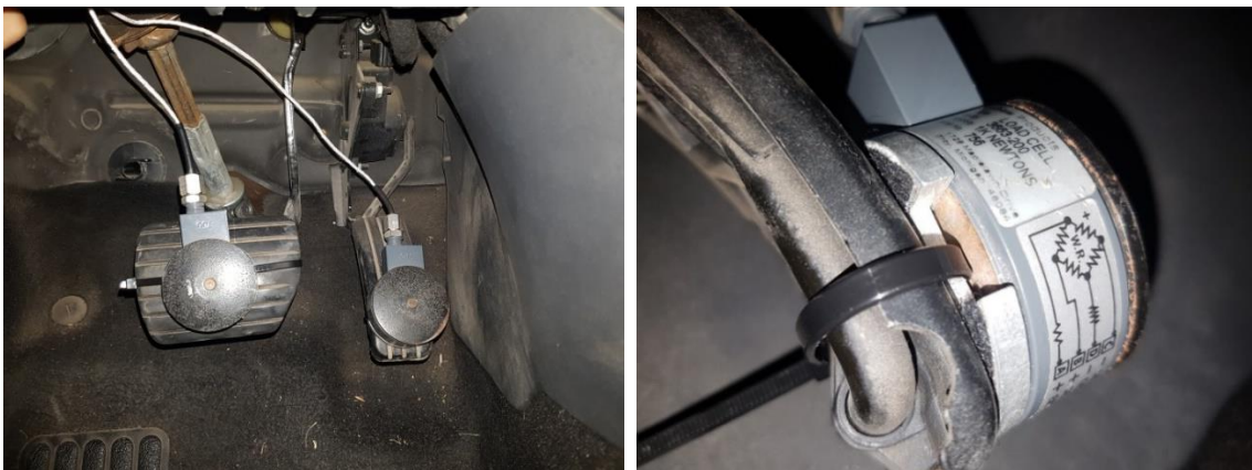
Figura 12. Células de carga instaladas en los pedales con detalle de la brida para su montaje.
