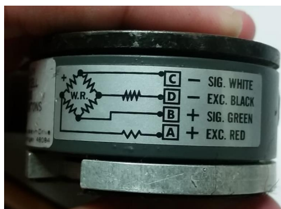
Figura 4. Circuito con puente de Wheatstone que incorpora la célula
