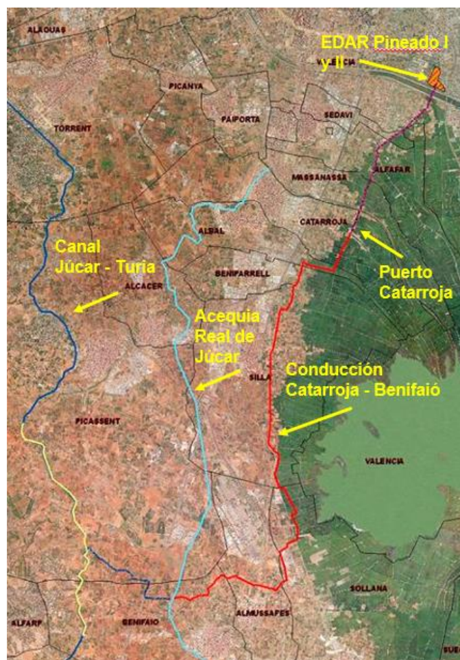
Figura 1 Proyecto de reutilización de aguas residuales de la planta de Pinedo (CHJ)
