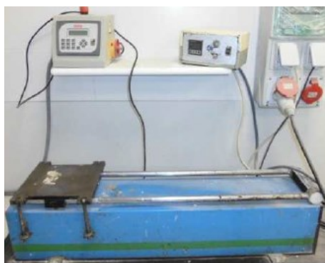
Figura 84 Compactadora PROETI, G.A.
