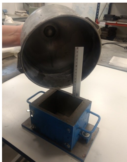
Figura 83 Distancia de vertido en las probetas de 10 x 10 x 10 cm.
