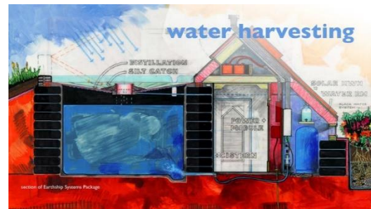
Figura 3 y 4. Principios básicos de diseño de una earthship.
