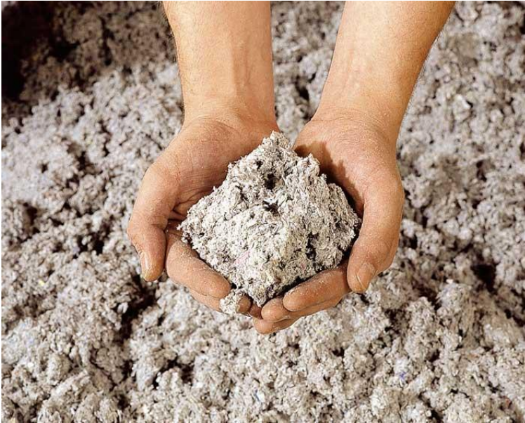
Figura 29. Aislamiento de celulosa de papel de periódico reciclado.
