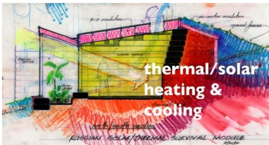
Figura 3 y 4. Principios básicos de diseño de una earthship.
