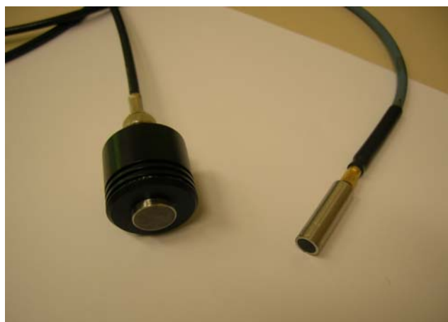
Figura 5.3. Transductores Panametrics M103 y Panametrics 310S utilizados para la adquisición de las señales ultrasónicas experimentales objeto de esta tesis.
