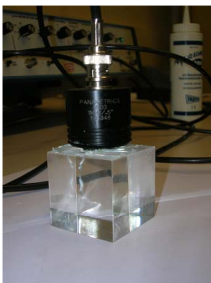
Figura 5.5. Detalle del proceso de medida en la pieza metacrilato, para la obtención de las respuestas pulso-eco de los transductores.
