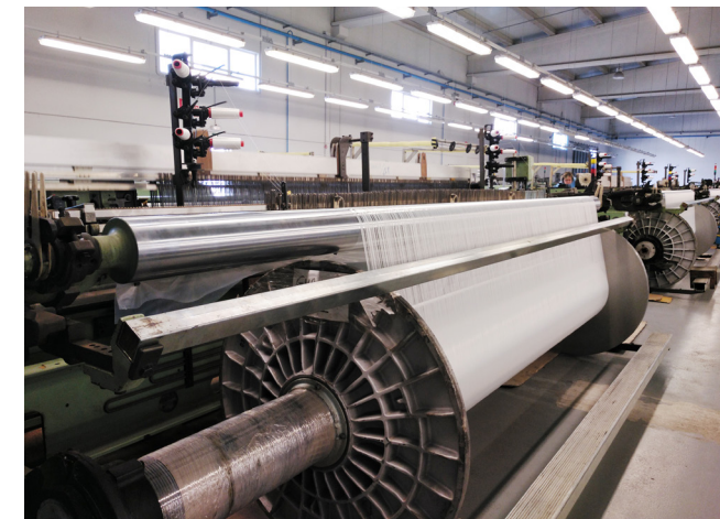
Fig. 5.14 Tejido del poliéster en telares. Industrial Sedó. Imagen propia.
