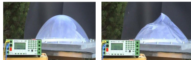
Fig. 6.12 Ensayo de explosión en membrana de ETFE. Imagen de Blum, Bögner-Balz y Köhnlein.
