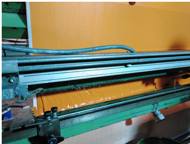
Fig. 5.16 Revestimiento del tejido de poliéster. Industrial Sedó. Imagen propia.
