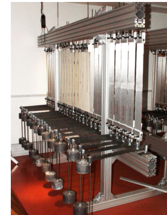
Fig. 6.7 Ensayo de cargas a largo plazo. Imágenes de Laboratorio Blum.
