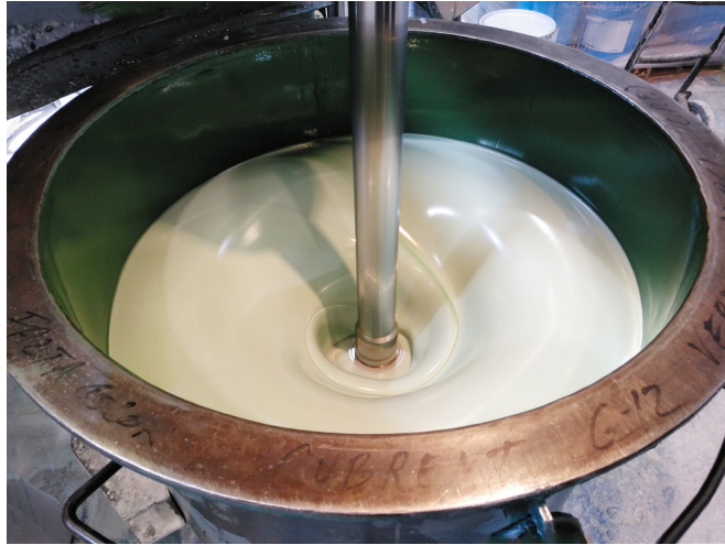
Fig. 5.15 Preparación de la mezcla de PVC. Industrial Sedó. Imagen propia.
