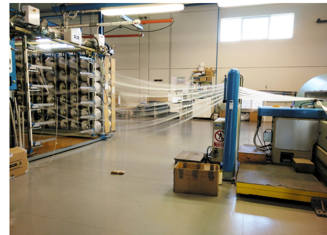
Fig. 5.13 Preparación de los carretes de hilo de poliéster. Industrial Sedó. Imagen propia.
