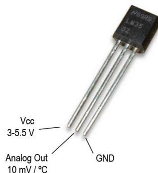
Figura 3.19. Sensor de Temperatura LM35.
