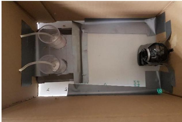
Figura 3.6. Sistema de visión depósito de hidrógeno.
