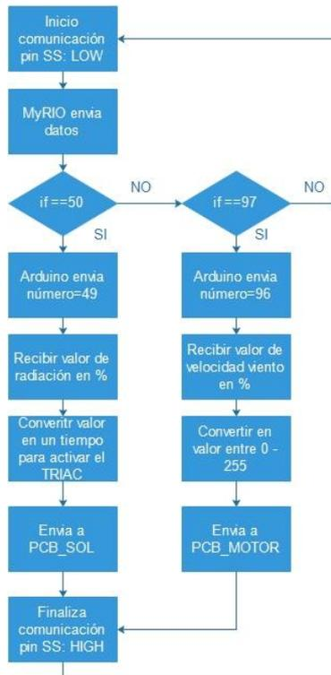
Figura 3.27. Flujograma Arduino.
