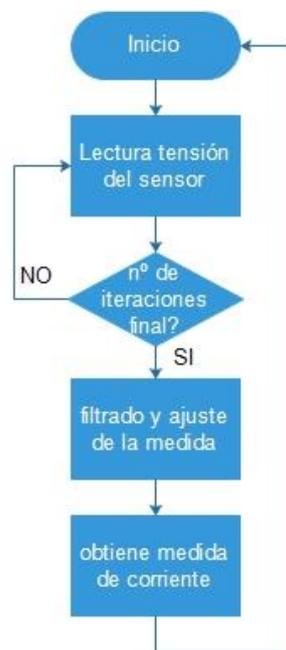
Figura 3.30 Flujograma sensor de corriente.
