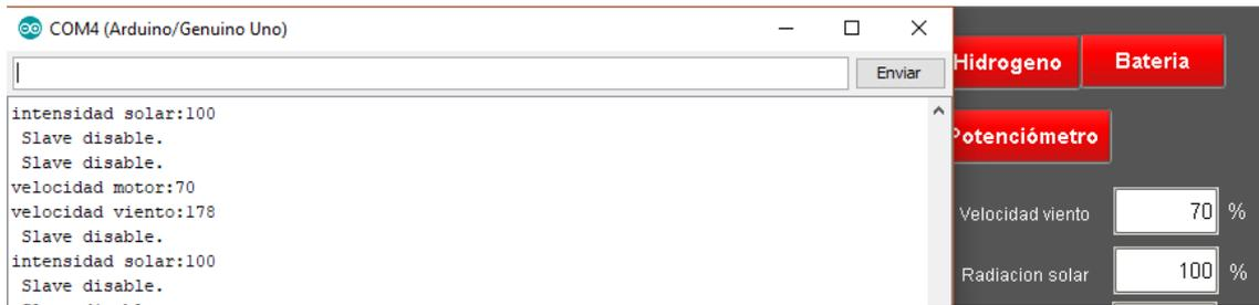
Figura 4.2. Pantalla comunicación serial Arduino(izquierda) y datos SCADA.
