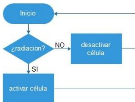
Figura 3.43. Flujograma radiación
