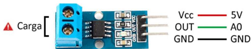
Figura 3.9. Sensor de corriente.
