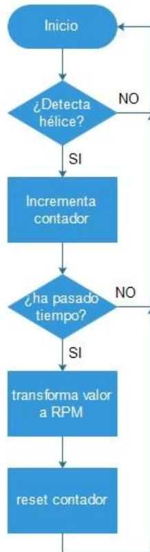
Figura 3.28. Flujograma contador RPM.
