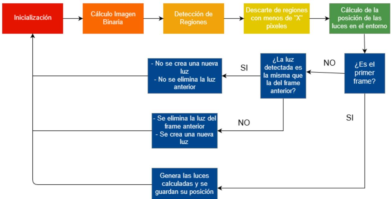
Figura 23. Diagrama del algoritmo de detección de luces
