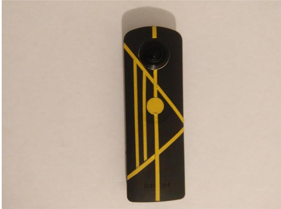
Figura 16. Cámara 360° con geometría extra para el ModelTarget
