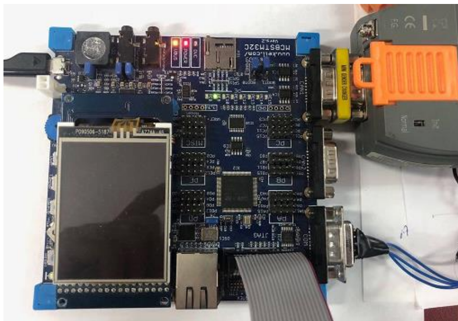
Figura 74. Led de error por parámetros anómalos en el BMS
