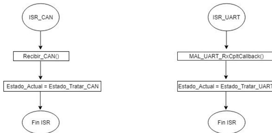
Figura 41. Diagrama de flujo de las interrupciones
