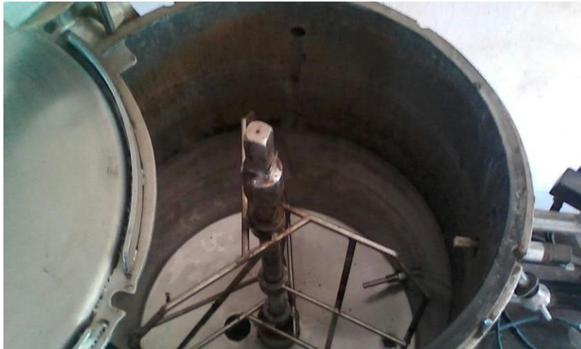
Figura 7. Interior del biorreactor
