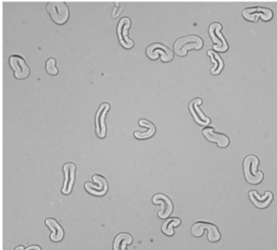
Figura 1.4. Secciones transversales de fibras de algodón incrustadas en resina de metacrilato de metilbutilo que muestran la pared y el lumen de la fibra. 20
