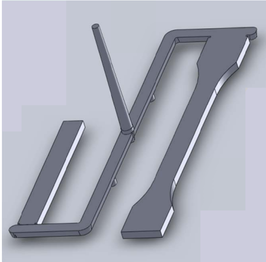
Figura III-1. Geometría del molde empleado en el moldeo por inyección de material basado en mezclas de SEBS.
