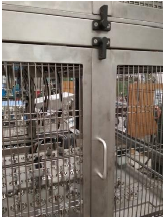
Ilustración 49 Vista detalle bloqueo puertas
