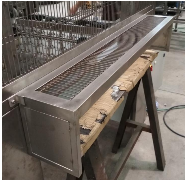
Ilustración 47 Vista protección entrada producto
