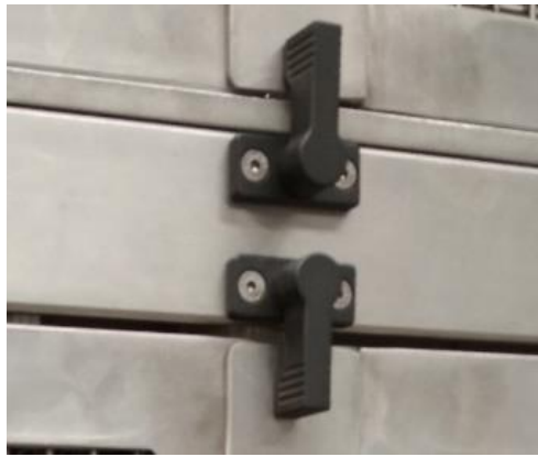
Ilustración 49 Vista detalle bloqueo puertas
