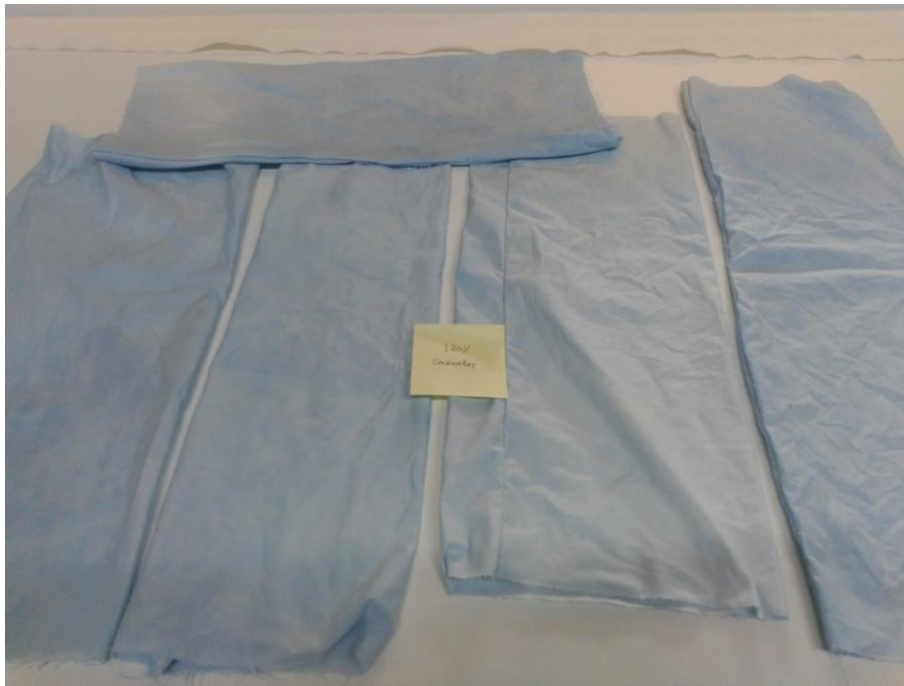
Fig. 28: ensayo 1kg de camales del tejido base al 120% de NPB
