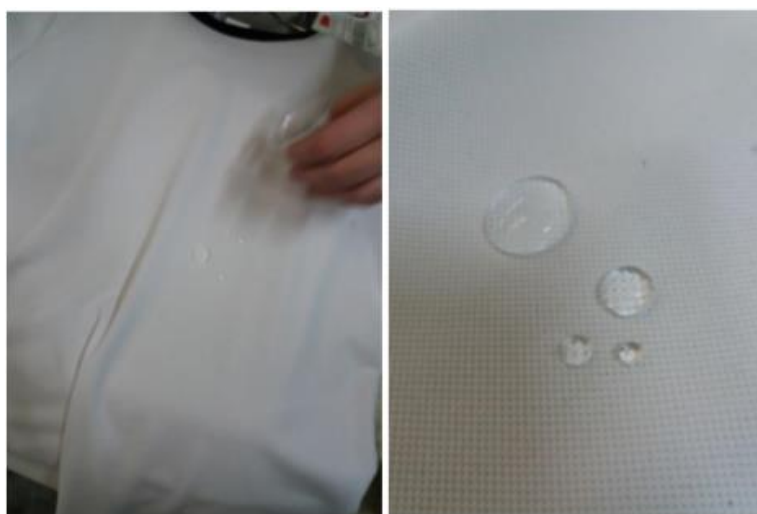
Fig. 31: pruebas de repelencia a líquidos con acabados a 35g/L
