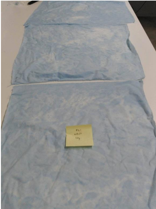
Fig. 25: ensayo de 1kg de tejido al 80% de NPB
