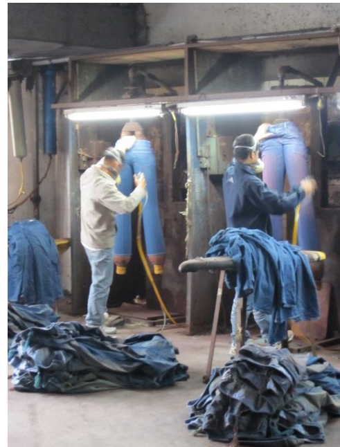
Fig. 3: técnica de sprayado de PP
