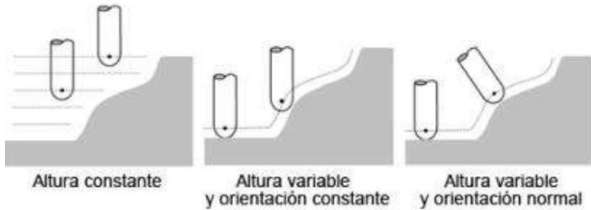
Figura 39. Elección de diferentes trayectorias de mecanizado
