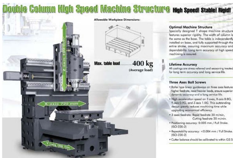
Figura 46. Estructura y dimensiones de trabajo GT-66V
