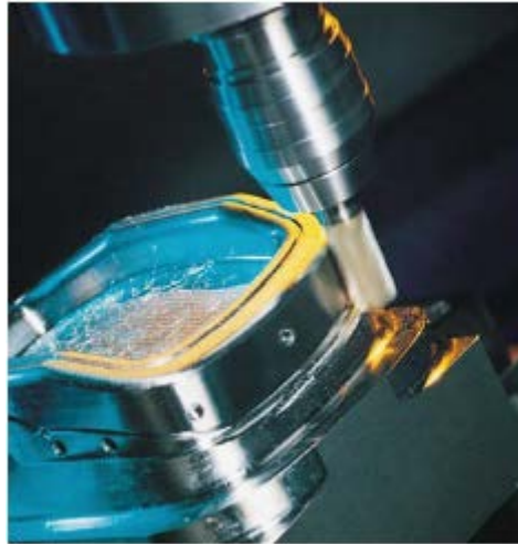
Figura 35. Ejemplo de trayectoria de fresado de flanco
