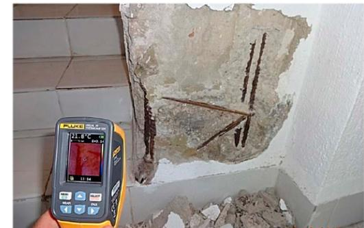
Medición mediante infrarrojos.
