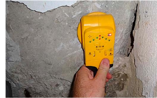
Medición mediante pachometro.
