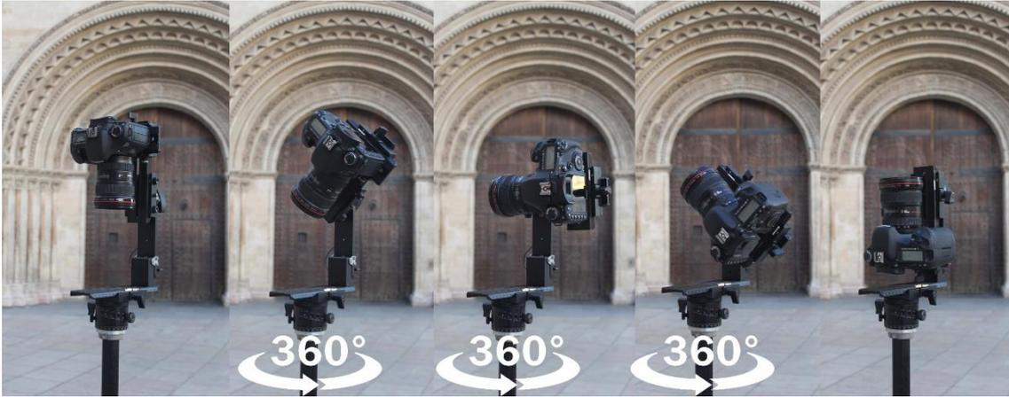
*Imagen 52. Rotación de la cámara vertical a  $-90^\circ$ ,  $-45^\circ$ ,  $0^\circ$ ,  $45^\circ$  y  $90^\circ$  respectivamente. (Fuente propia, 2018)*
