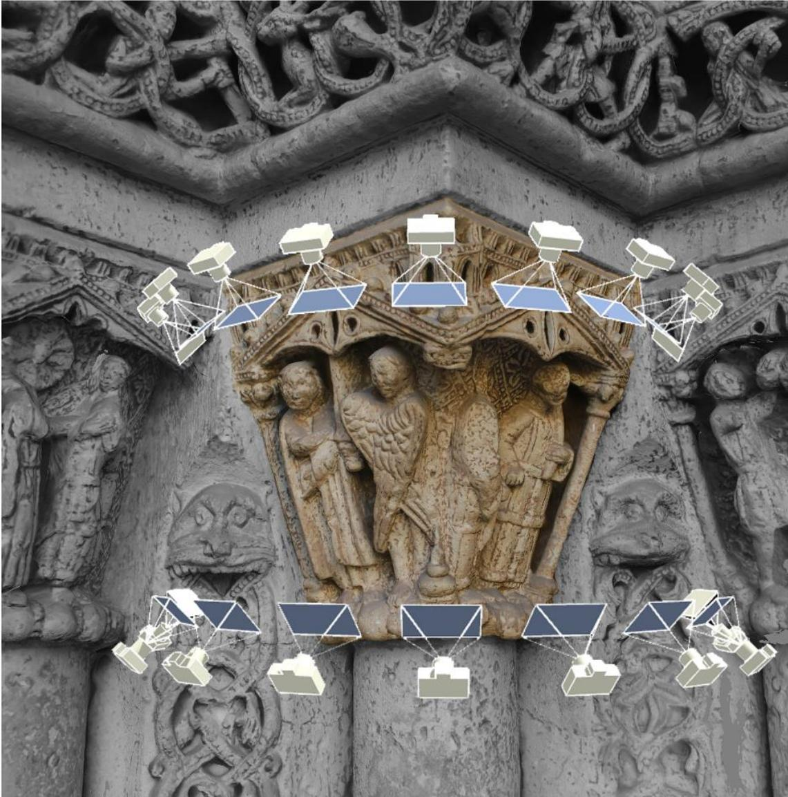
Imagen 57. Esquema del posicionamiento de la cámara en relación al capitel (Fuente propia, 2018)
