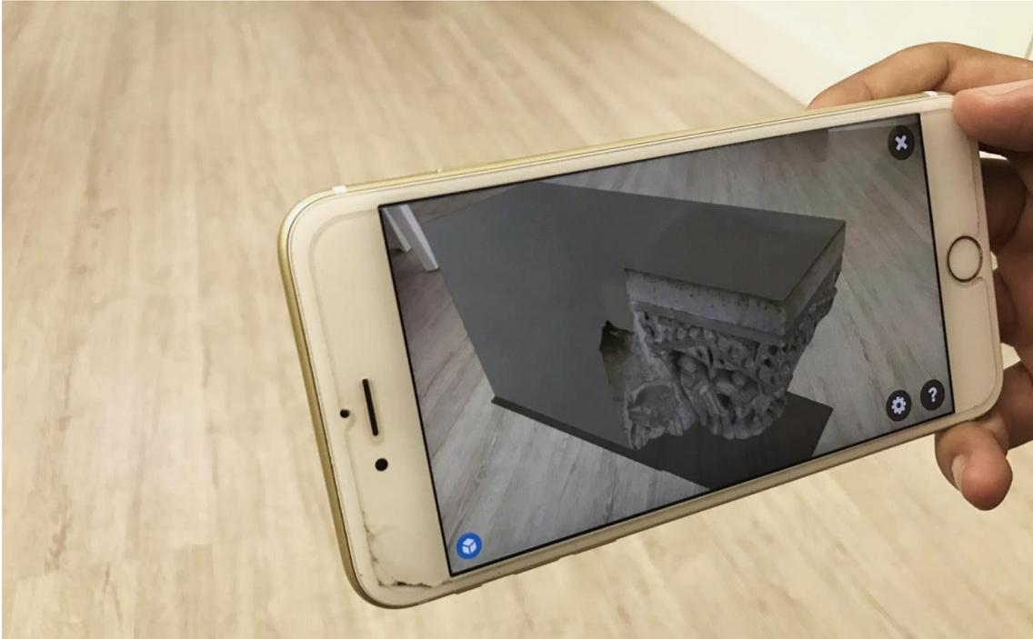
*Imagen 48. Realidad aumentada de un capitel de la puerta del Palau con la App de Sketchfab, sin necesidad de imagen de referencia, detecta la superficie de forma automática. (Fuente Propia, 2018)*
