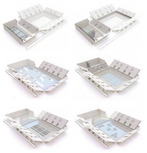
Fig. 22. Posibles configuraciones del Navarra arena:
