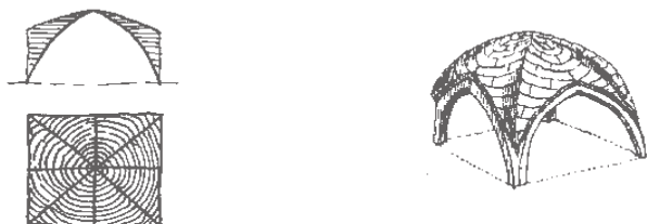
Figura 38. Aproximaciones de los tipos de bóvedas según Viollet Le Duc (Navarro Fajardo)
