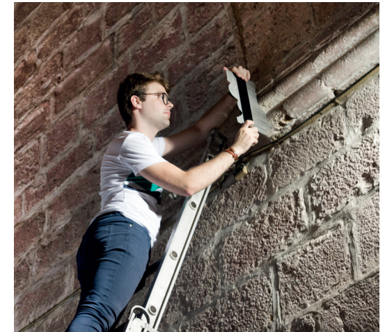
Fig.95. Adrián Pastor tomando el perfil del arranque del arco fajón de la capilla mediante el peine de arqueólogo.
