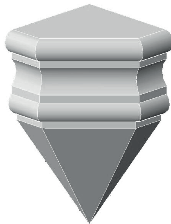
Fig.120. Modelo 3D de la ménsula (Dibujo propio)
