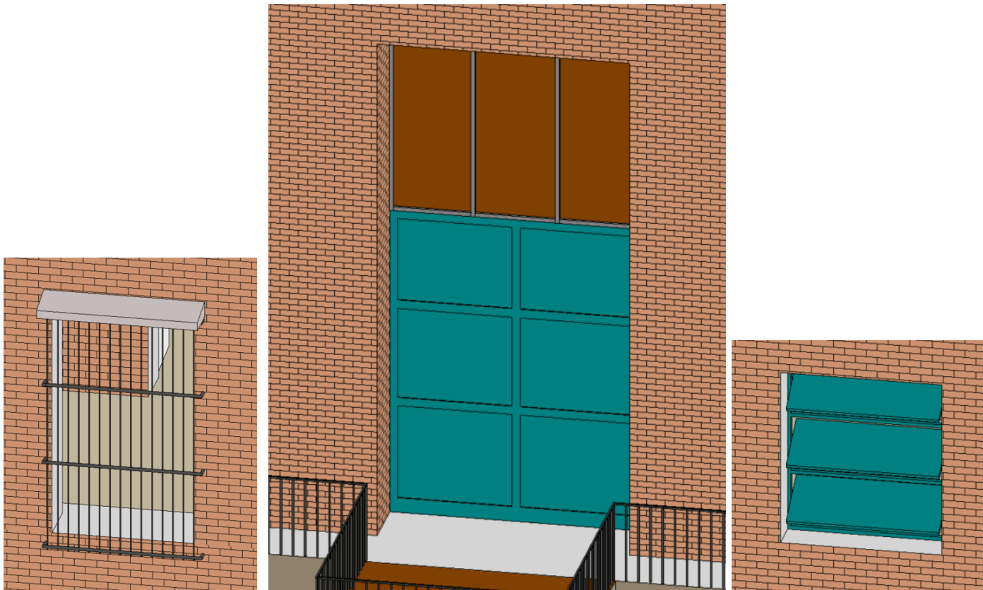
Figura 52: Cerrajería, ventanas y Puerta Regia localizados en la fachada norte del teatro.
