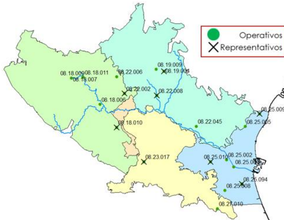
Figura 26. Piezómetros de la red operativa y representativa de la zona de estudio. Fuente: propia.
