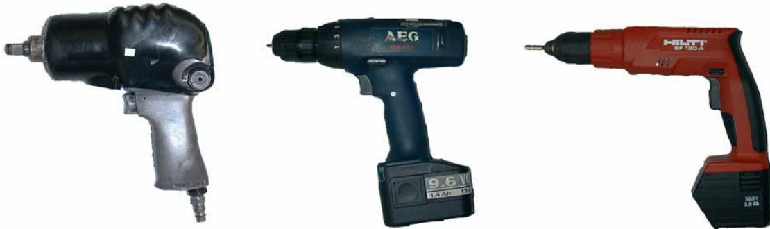
Figura 2.1. Perteneciente al trabajo de Mondragón et. al. (2005) en la que se observan destornilladores robustos (izquierda) frente a frágiles (derecha).
