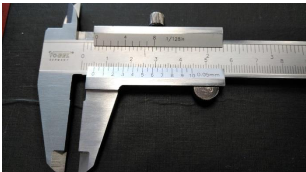
Figura 14: Calibre calibrado propiedad del MUSEJE utilizado en la toma de medidas destinadas al escalado de la pieza.
