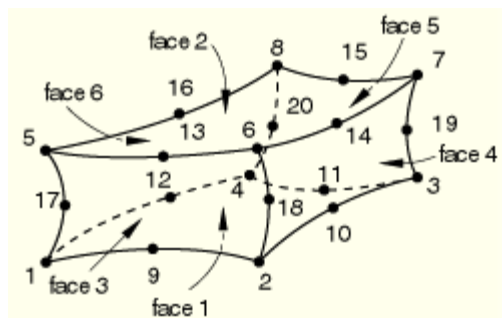
Figura 3.4 Elemento 3D cuadrático de 20 nodos (C3D20) utilizado en el mallado de los modelos de las placas.
